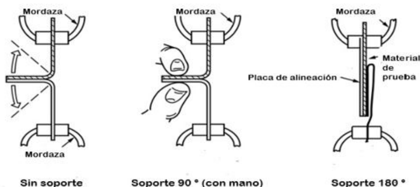
Figura 2.3. Técnicas adecuadas para la prueba de fuerza de sello (ASTM International, 2013)
