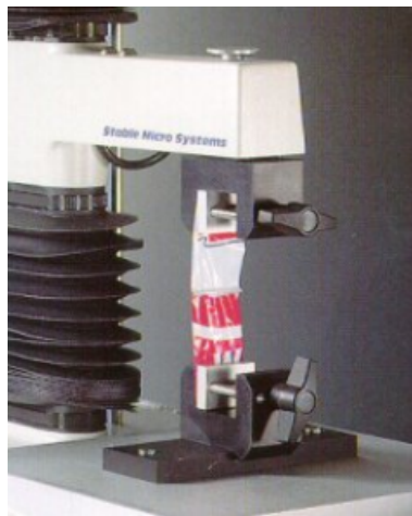
Figura 2.1. Diagrama del texturómetro con aditamentos para ensayo de fuerza de sello (Stable Micro Systems Ltd, 2016).
