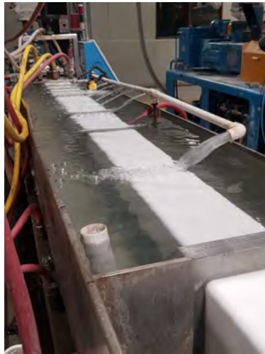
Figura 1.15. Tina de enfriamiento de perfiles de la empresa.
