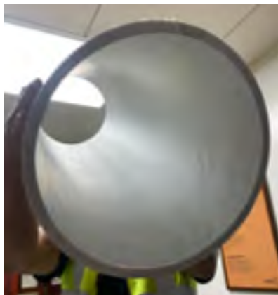
Figura 1.14. Mala apariencia interna en los productos no conformes del producto presión blanco.
