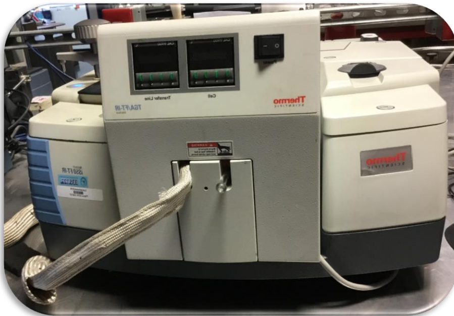
Figura 3.5. Equipo utilizado para realizar la prueba de espectroscopía infrarroja (Foto tomada en el Laboratorio de Materiales para Pavimentos, LANAME)
