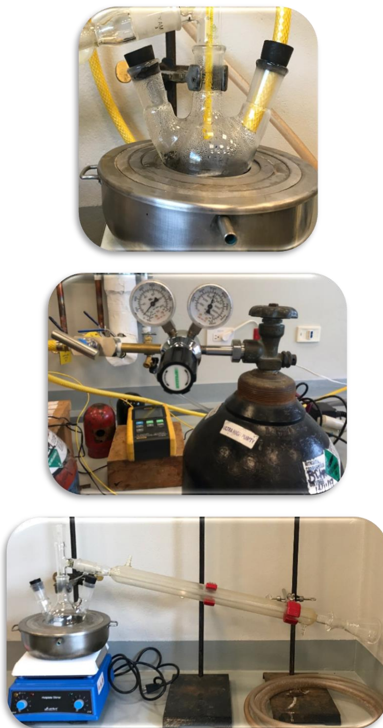
Figura 3.3. Montaje 2 de equipo experimental en el cual se utilizó nitrógeno sin flujo constante (Fotos tomadas en laboratorio de ingeniería química)
