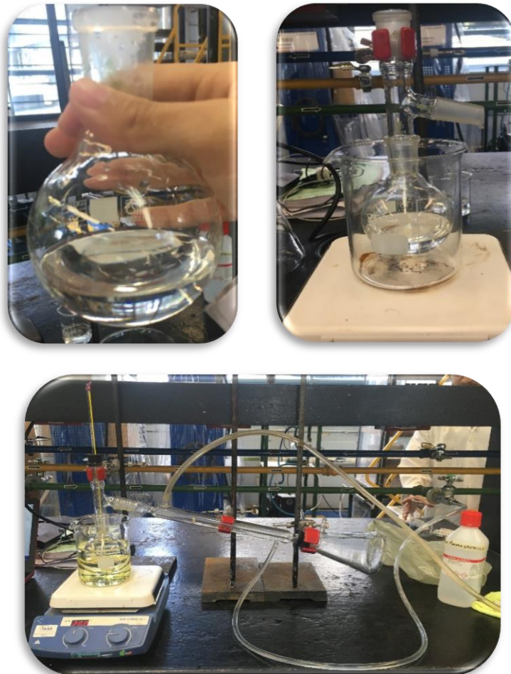
Figura 3.1. Montaje 1 de equipo experimental en el cual se utilizó un sistema de destilación al vacío (Fotos tomadas en laboratorio de Ingeniería química)
