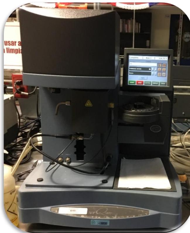
Figura 3.6. Equipo utilizado para realizar el análisis termogravimétrico (Foto tomada en el Laboratorio de Materiales para Pavimentos)
