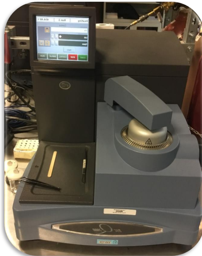
Figura 3.7. Equipo utilizado para realizar la prueba de calorimetría diferencial de barrido (Foto tomada en el Laboratorio de Materiales para Pavimentos)
