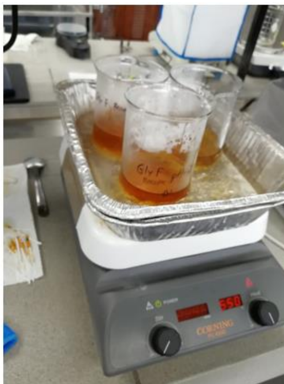
Figura 4.5 Eliminación de etanol y el agua disueltos mediante Baño María
