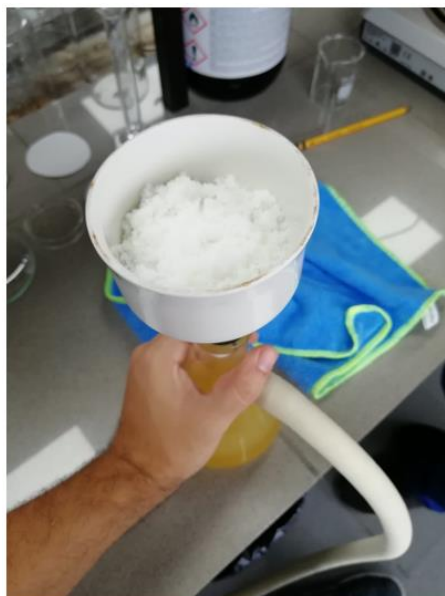
Figura 4.4 Sales retenidas en el proceso de filtración al vacío
