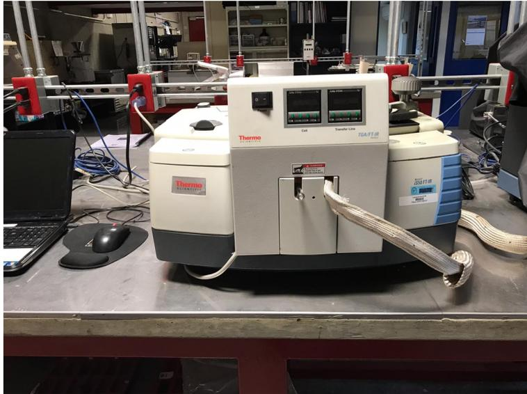
**Figura 5.8.** Foto del equipo FT-IR utilizado para obtener los espectros en infrarrojo
