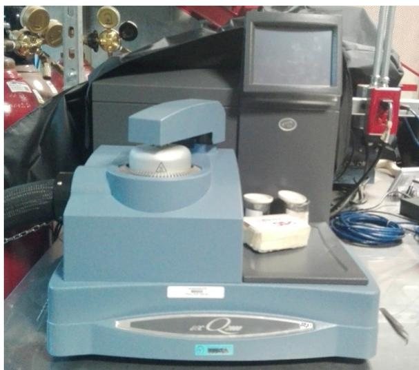
**Figura 5.9.** Foto del equipo DSC utilizado para la obtención del termograma
