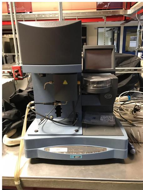
**Figura 5.11.** Imgen del equipo TGA utilizado para realizar el análisis termogravimétrico
