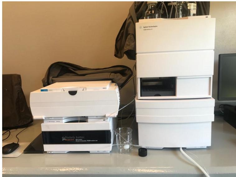
**Figura 5.13.** Equipo utilizado para realizar el análisis de cromatografía de permeación gel.
