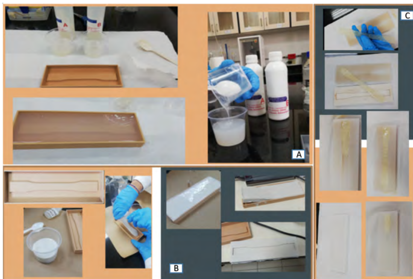
Figura 5.3: A) Fabricación de molde de silicón. B) Fabricación de molde de hule. C) Fabricación de probetas con pistola de aire. Fuente: Autor.
