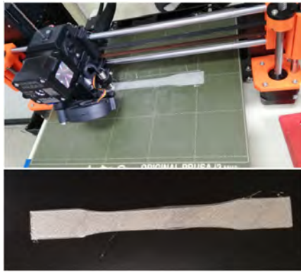
Figura 5.2: Probeta de PLA fabricada con impresión 3D. Fuente: Autor.
