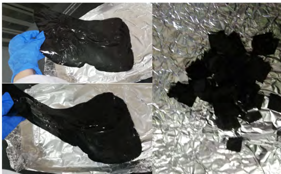
Figura 4.2: Lámina de material resultante de la dispersión de partículas en la matriz polimérica. Fuente: Autor.
