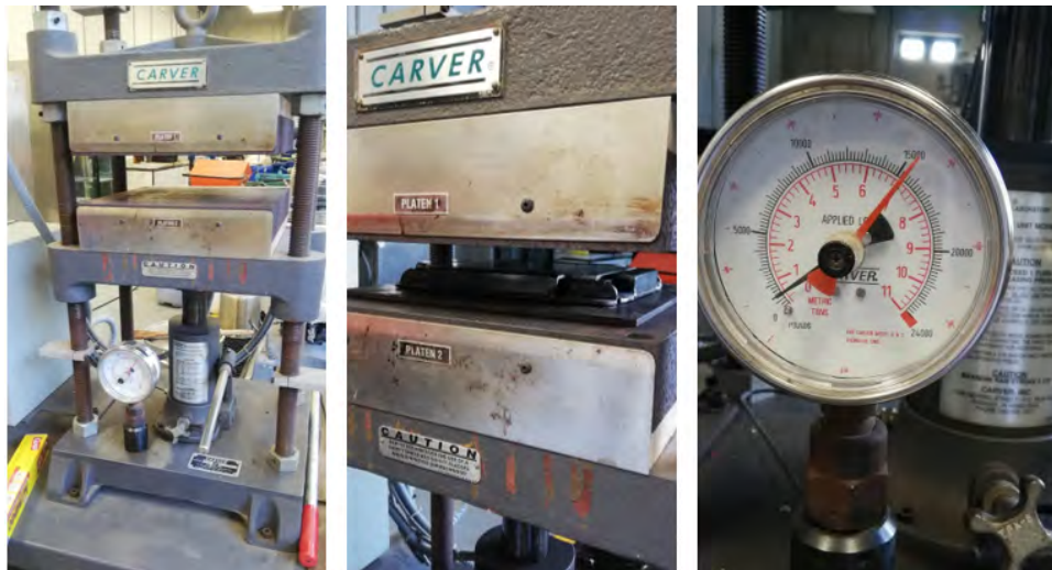
Figura 5.7: Prensa hidráulica utilizada para la confección de la lámina final de PLA proporcionada por el POLIUNA. Fuente: Autor
