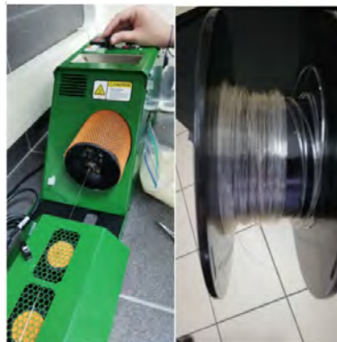
Figura 5.1: Extrusión de filamento de PLA. Fuente: Autor.
