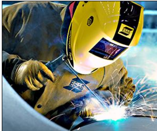
Figura 18. Aplicación de proceso de soldadura SMAW
