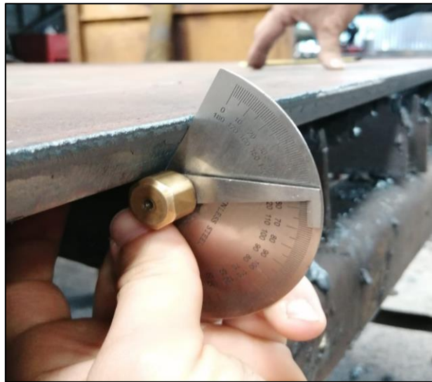
Figura 15. Verificación de ángulo de corte en biselado de lámina de 3/4" (19,05 mm) mediante oxicorte
