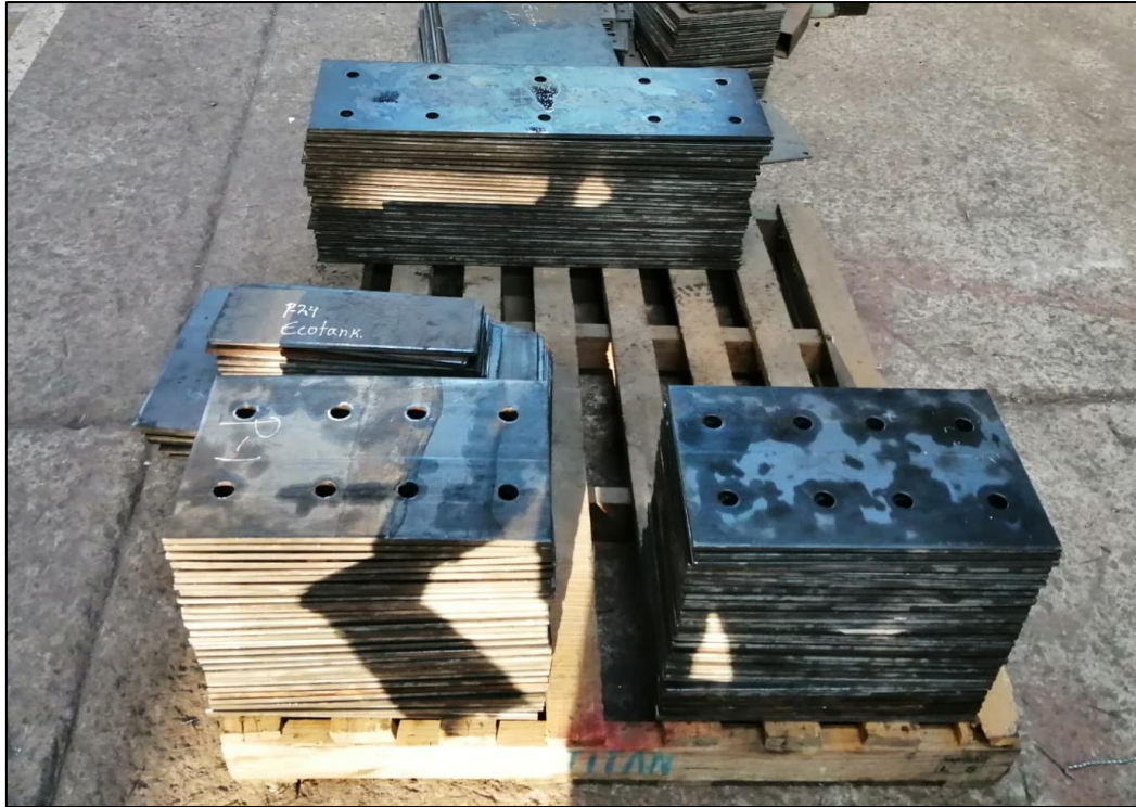
Figura 14. Placas perforadas mediante ponchadora
