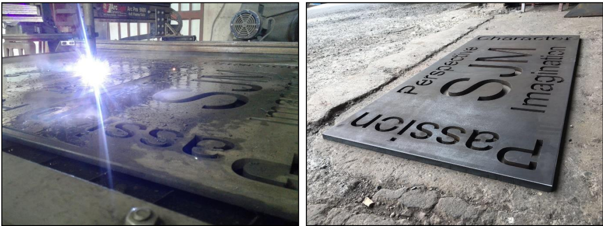
Figura 8. Funcionamiento de corte plasma mecanizado en lámina de 1/2" (12,7 mm) de acero A36
