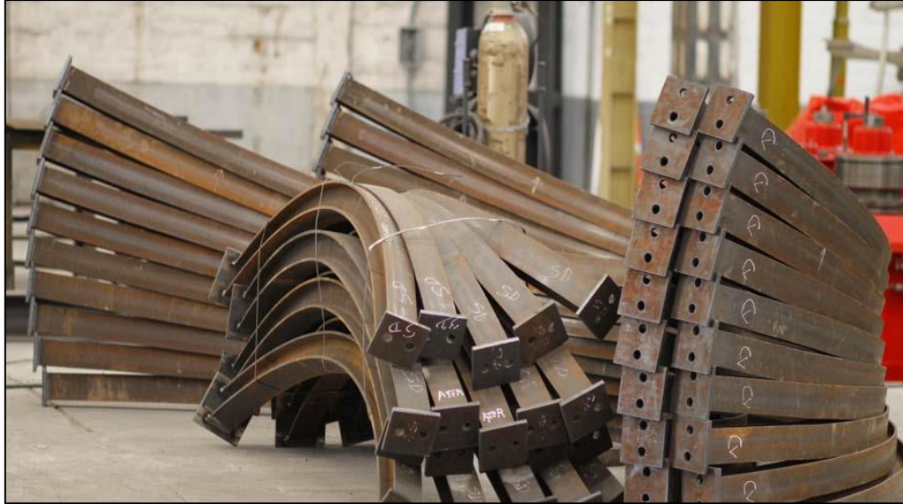
Figura 12. Vigas tipo H roladas
