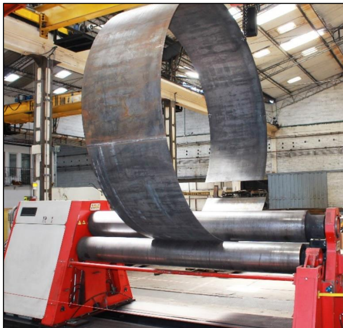
Figura 11. Aplicación del proceso de rolado en lámina Fuente: (Ferrocortes S.A.S - Soluciones con el acero, 2022)
