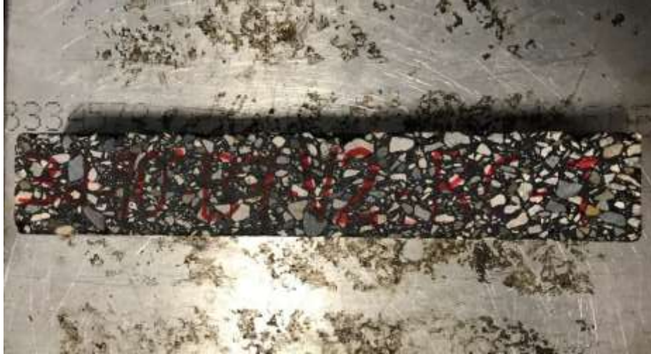
Figura 35. Viga con acondicionamiento de 3 días a 90 °C.
