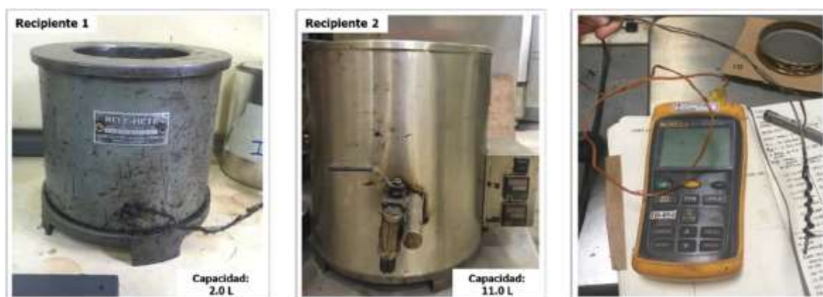
Figura 13. Equipo utilizado para modificar el asfalto con SBS.
