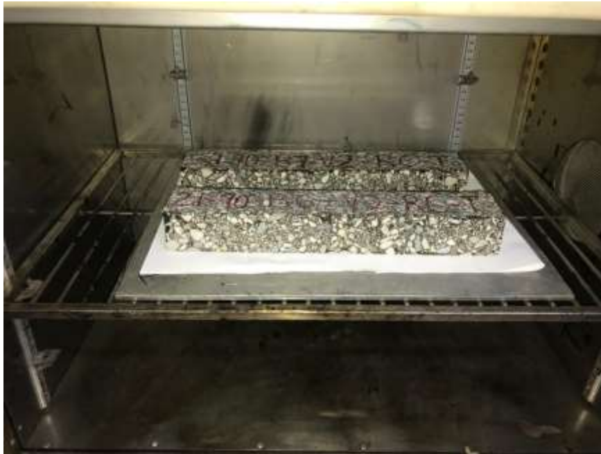
Figura 28. Acondicionamiento de vigas a 90 °C dentro de un horno.
