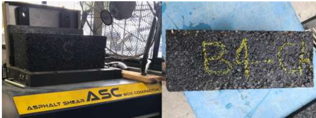
Figura 20. Bloques base de MAC compactados con el compactador ASC.
