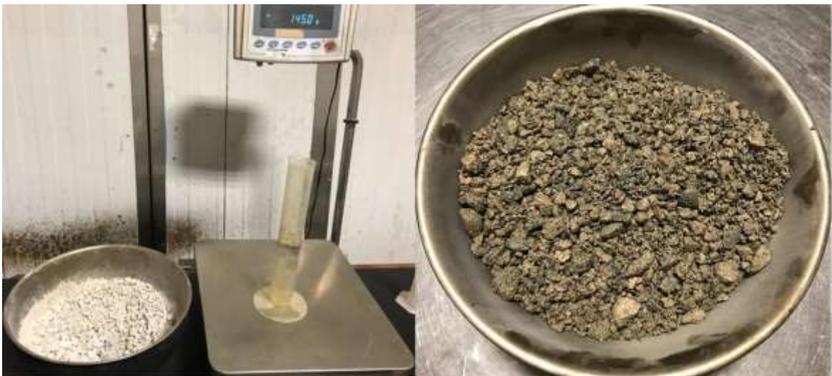
Figura 17. Proceso de adición y mezclado con el 1% de cal y el 4 % de agua.
