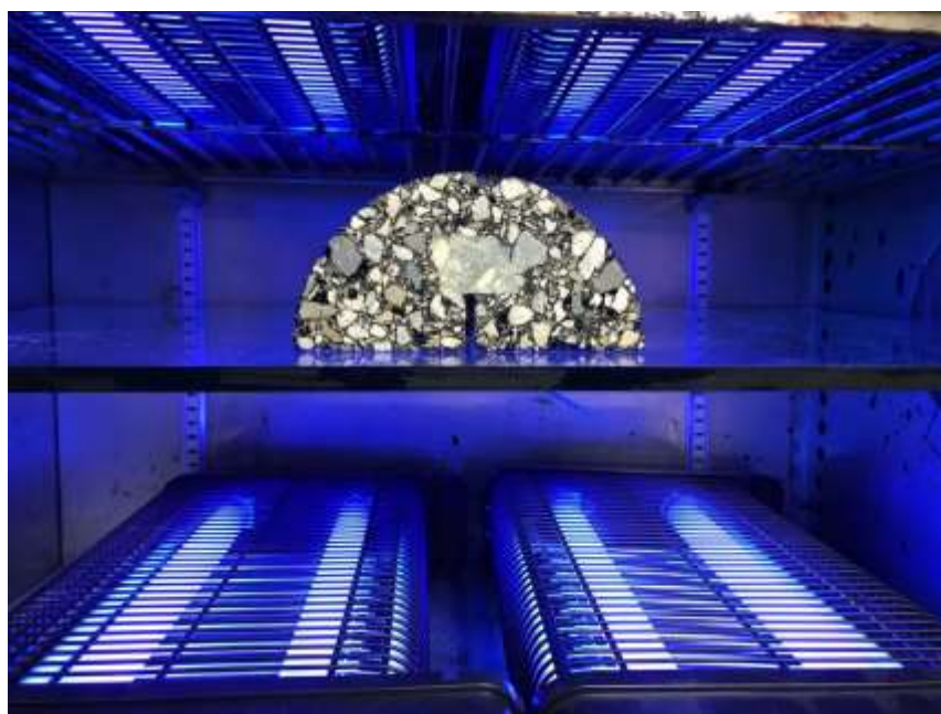
Figura 38. Especímenes SC en proceso de acondicionamiento.
