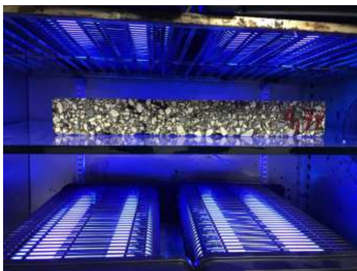
Figura 37. Configuración de la cámara de envejecimiento utilizada.
