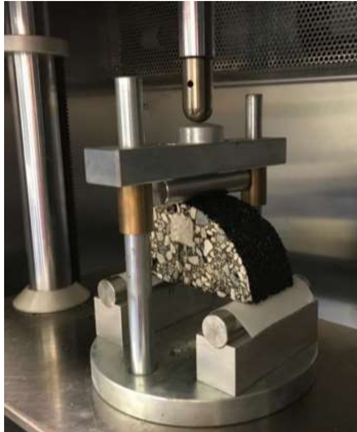
Figura 12. Montaje del ensayo de resistencia al agrietamiento con especímenes semicirculares.
