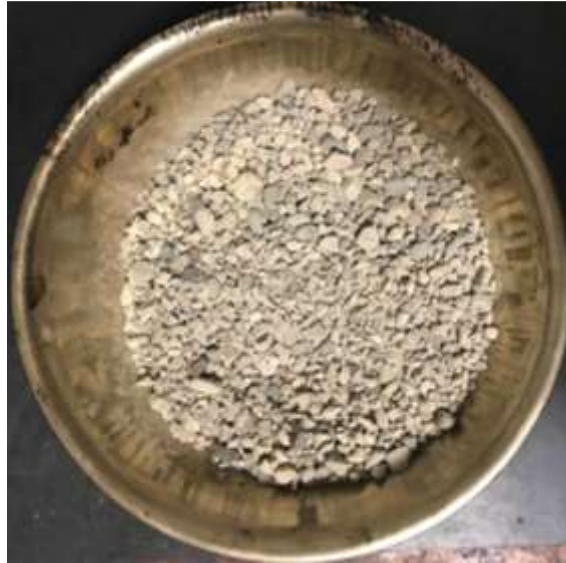
Figura 15. Ejemplo de granulometría utilizada para la mezcla de CT.
