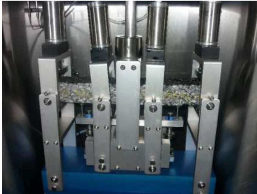
Figura 7. Ensayo de fatiga a cuatro puntos en mezcla asfáltica.
