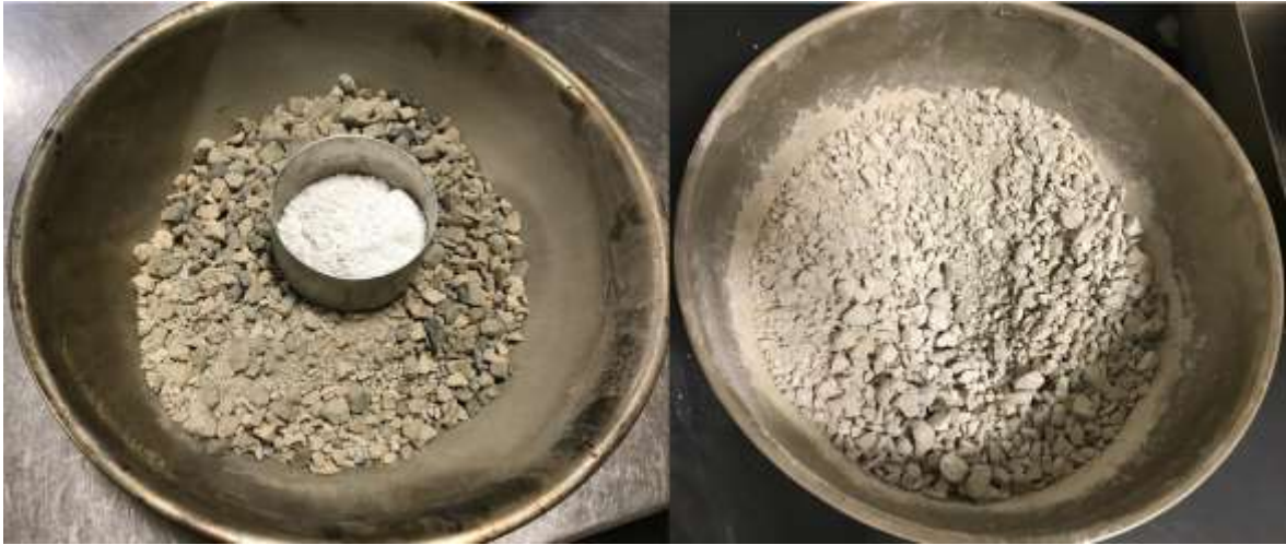
Figura 16. Proceso sustitución y mezclado en seco con el 1 % de cal.
