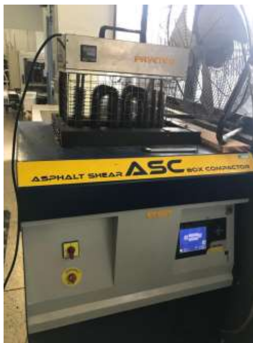
Figura 19. Compactador ASC utilizado para elaborar los bloques de MAC.
