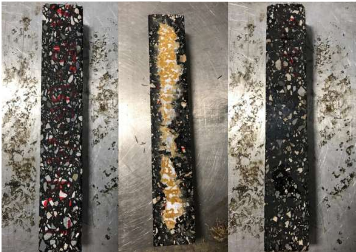
Figura 34. Película de asfalto formada en la parte inferior del espécimen envejecido 2 días a 95 °C.
