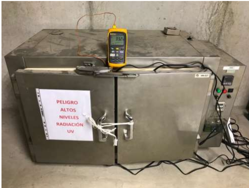
Figura 39. Monitoreo térmico durante el envejecimiento por radiación UV aplicado.
