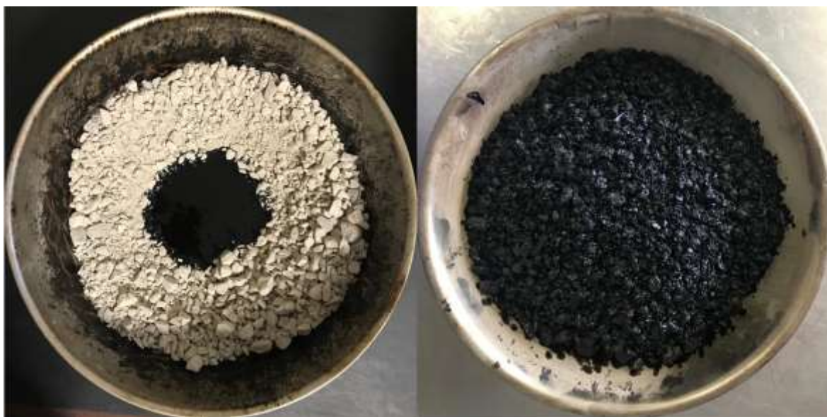
Figura 18. Adición de asfalto y mezclado final de las MAC.
