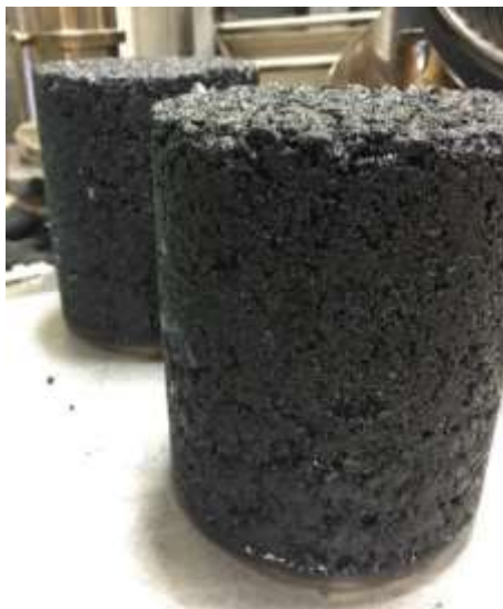
Figura 22. Ejemplares cilíndricos compactados con ayuda del CGS.
