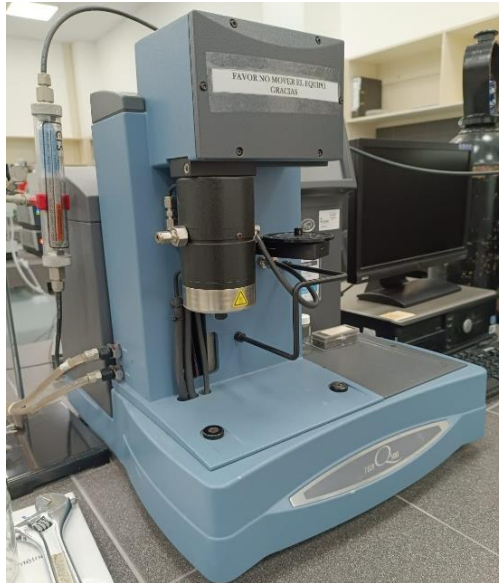
Figura 3. Analizador termogravimétrico TGA-Q500, TA Instruments.
