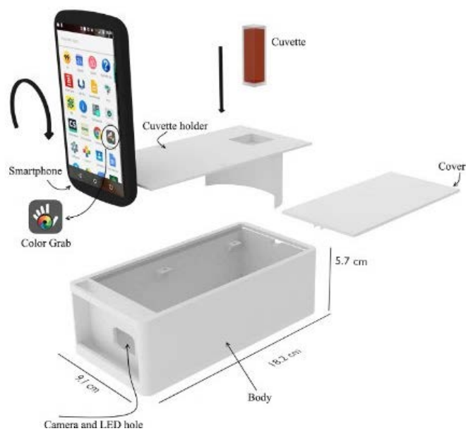
Figura 17. Caja de luz utilizada en la determinación de Fe (III) en biodiesel mediante el uso de un teléfono celular. Tomada de: "Iron (III) determination in bioethanol fuel using a smartphone-based device", por A.F. João, et al., 2019, Microchemical Journal , 146.
