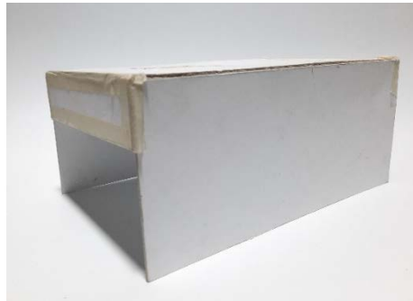
Figura 28. Complemento del prototipo 4.1.1 para aumentar en 2.5 cm la distancia entre la celda de medición y la cámara del teléfono Samsung A51.
