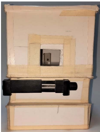
Figura 27. Exterior del prototipo 3.2.1 del dispositivo diseñado para controlar las condiciones de iluminación durante la obtención de coordenadas de color con el teléfono Samsung A51.
