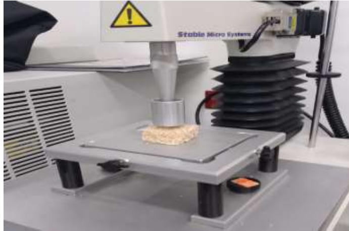
Figura 4. Compresión de la muestra de pan integral de molde, utilizando el analizador de textura TA. TXPlus.
