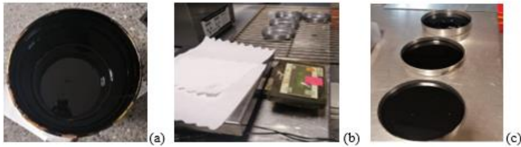
Figura 3. 9. Proceso de preparación de muestras: a) Muestra original; b) Pesaje de muestra vertida; c) Muestras para ensayar.
