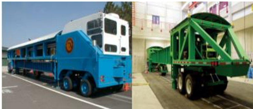
Figura 2.4. Ejemplos de unidades HVS: a la izquierda la unidad del FDOT y a la derecha la unidad del LanammeUCR.
