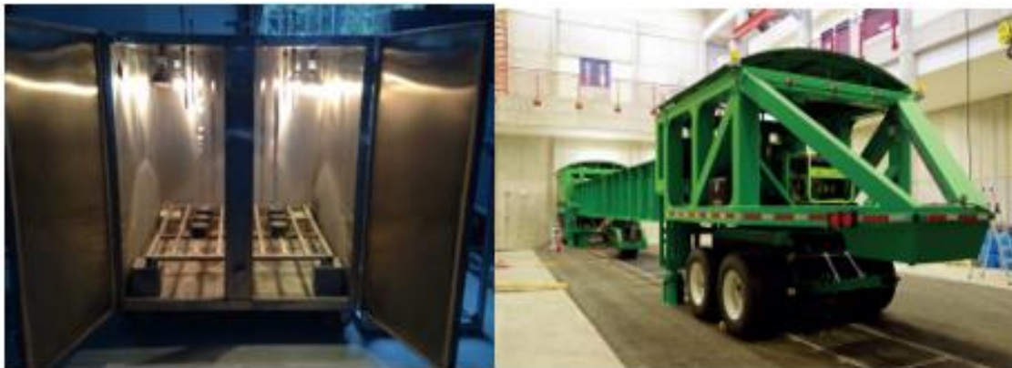
Figura 1.4. Equipos para ensayos de envejecimiento acelerado por meteorización: a la izquierda una cámara hecha con base en la norma ASTM D4799; a la derecha el simulador de vehículos pesados (HVS).
