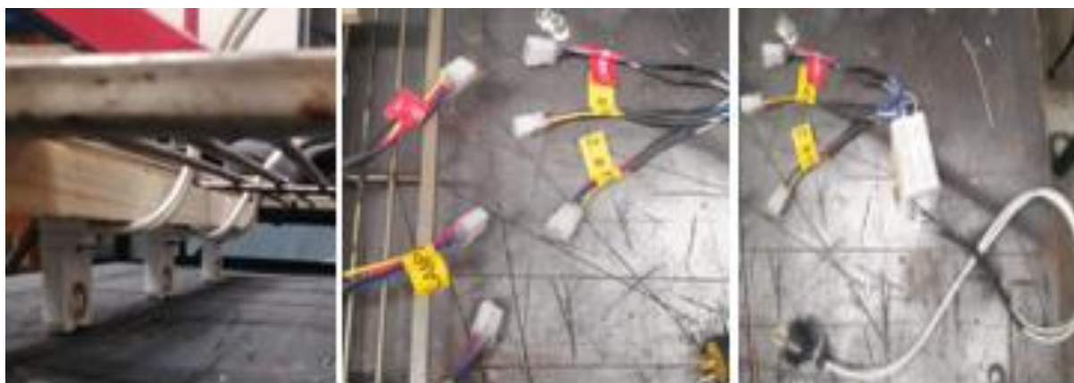
Figura 2.16. Detalle del sistema de radiación. A la izquierda las bases de contacto para los bombillos UV; al centro el sistema de acople rápido y, a la derecha, los balastos de regulación.
