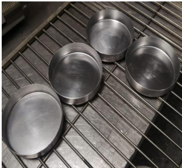
Figura 2.20. Portamuestras de aluminio colocados en la configuración de ensayo.
