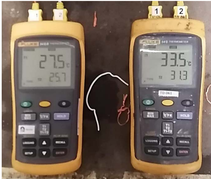
Figura 2.11. Termopares empleados en la comprobación térmica del EEMA.
