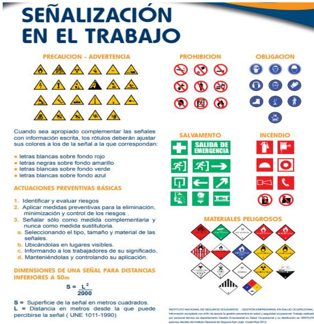
Figura 2.7. Señalización de seguridad en los sitios de trabajo propuesta por el INS. Fuente: (INS, 2012).
