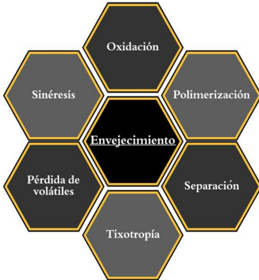
Figura 1. 3. Esquema sobre los principales mecanismos que conforman el fenómeno de envejecimiento de los asfaltos.
