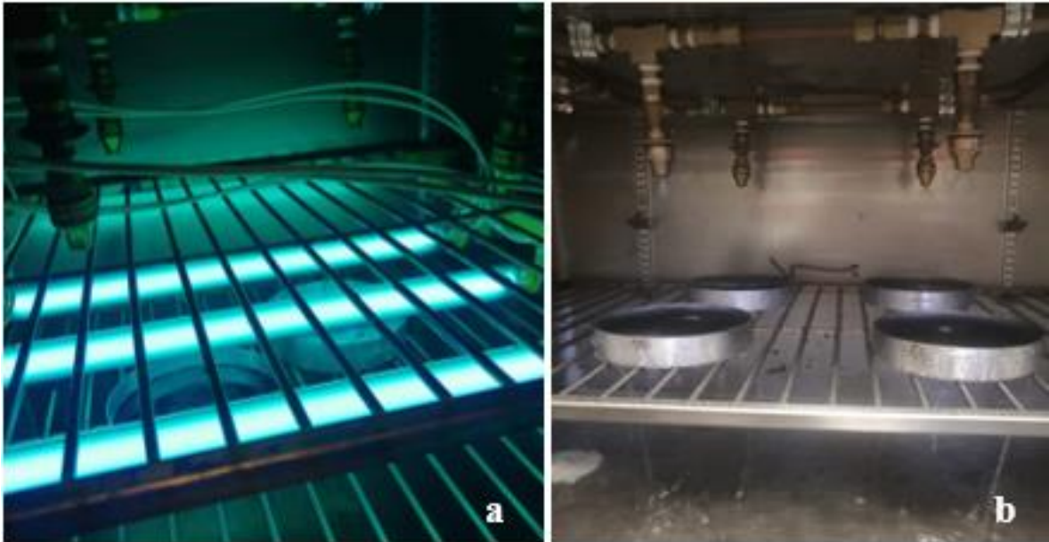
Figura 3. 11. Muestras asfálticas en proceso de envejecimiento en el EEMA: a) Muestras C y F durante el subciclo de radiación, y b) Muestras B, C, E y F durante el subciclo de precipitación.
