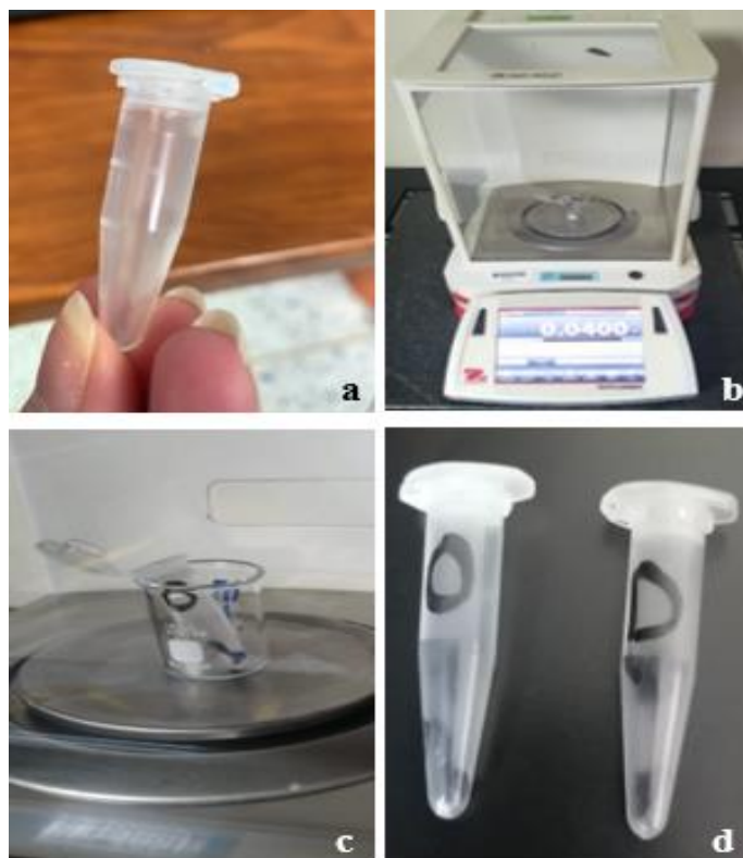
Figura 3. 15. Proceso de muestreo de especímenes para RMN: a) Tubo Eppendorf; b) Balanza analítica; c) Colocación del Eppendorf para pesaje; d) Muestras listas para RMN.
