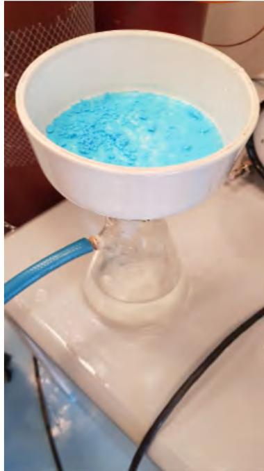
**Figura 3.2.** Filtrado al vacío
