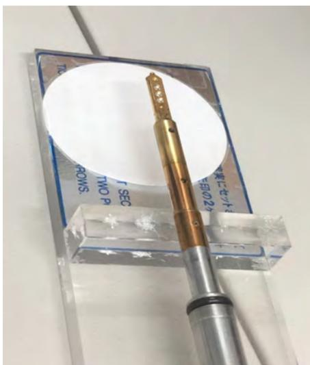
**Figura 3.8.** Rejilla en brazo utilizada en técnica TEM
