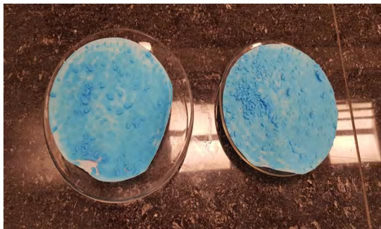
**Figura 3.3.** Catalizador filtrado para posterior secado
