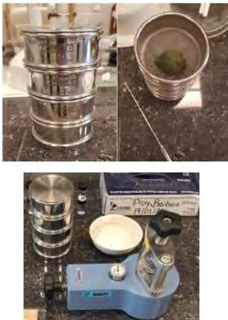
**Figura 3.4.** Torre de tamices y prensa para empastillado
