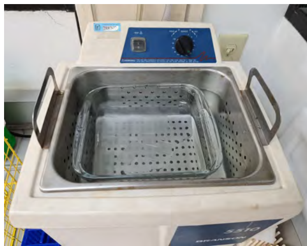
Figura 3.4. Proceso de limpieza de los sustratos de vidrio en el equipo para baño ultrasónico Branson 5510.
