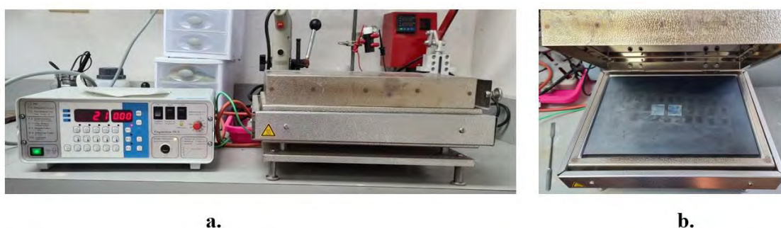
Figura 3.7. Sistema empleado para la rampa de temperatura conformado por: a) Controlador y plantilla de calentamiento, b. Interior de la plantilla de calentamiento.
