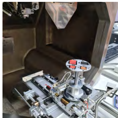
Figura 3.21. Sistema para la realización del análisis EDX. a. Perovskita depositada y en polvo en el portamuestras, b. Portamuestras dentro de la cámara del equipo. Fuente: Elaboración propia, 2022.
