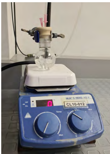
Figura 3.13. Sistema empleado para el burbujeo de CO 2 al NaOH. Fuente: Elaboración propia, 2022.
