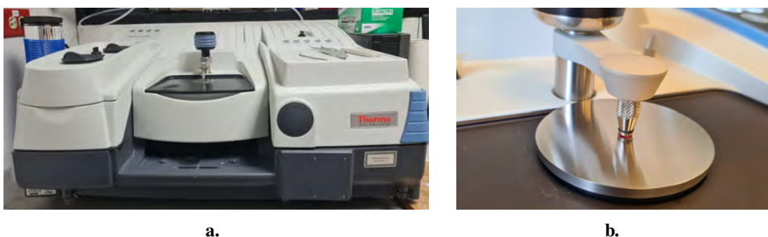
Figura 3.19. Sistema para la obtención del espectro infrarrojo. a. Equipo Discovery Nicolet 6700, b. Barra de compresión con la muestra de perovskita en el cristal.
