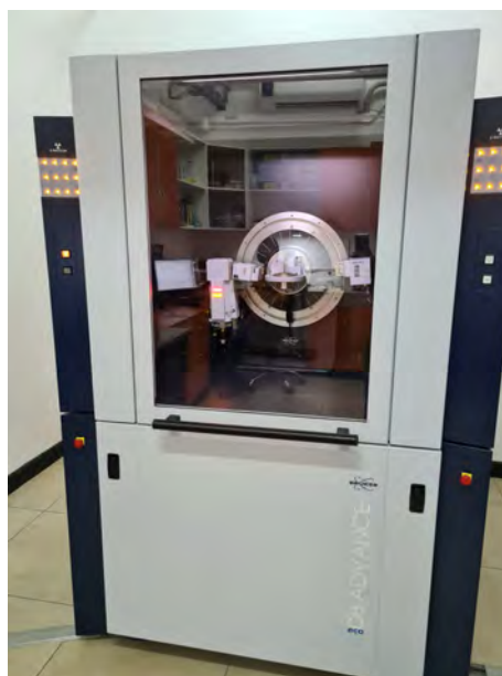
Figura 3.16. Equipo Brüker D8 Eco Advance empleado para el análisis XRD de las perovskitas.
