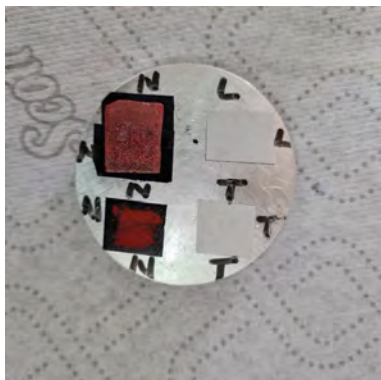
Figura 3.21. Sistema para la realización del análisis EDX. a. Perovskita depositada y en polvo en el portamuestras, b. Portamuestras dentro de la cámara del equipo. Fuente: Elaboración propia, 2022.
