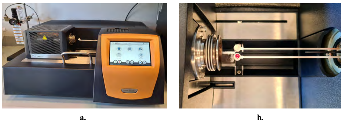
Figura 3.18. Sistema para la realización del análisis TGA y DSC. a. Equipo Discovery SDT 650, b. Portamuestras con la cápsula con perovskita y la cápsula vacía
