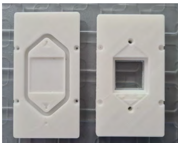
Figura 3.9. Tapas de HIPS impresas y lijadas. Fuente: Elaboración propia, 2022.
