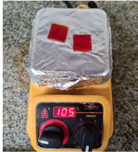
Figura 3.5. Sistema empleado con la plantilla de calentamiento para la deposición mediante drop casting.
