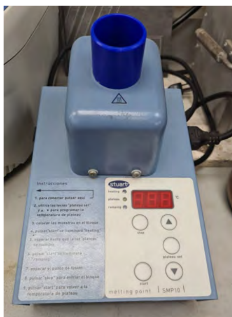
Figura 3.17. Equipo Melt Temp utilizado para el análisis del punto de fusión de las perovskitas.
