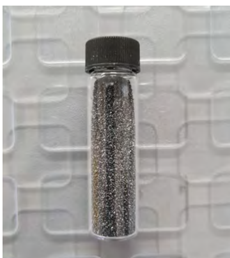
Figura 3.2. Partículas de carburo de silicio empleado para el aumento de la rugosidad de la superficie del sustrato
