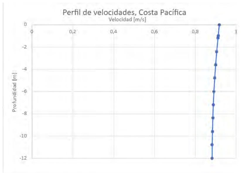
Figura 2.5: Ejemplo de perfil de velocidades horizontales de las partículas en un caso típico de oleaje de Costa Pacífica de Costa Rica
