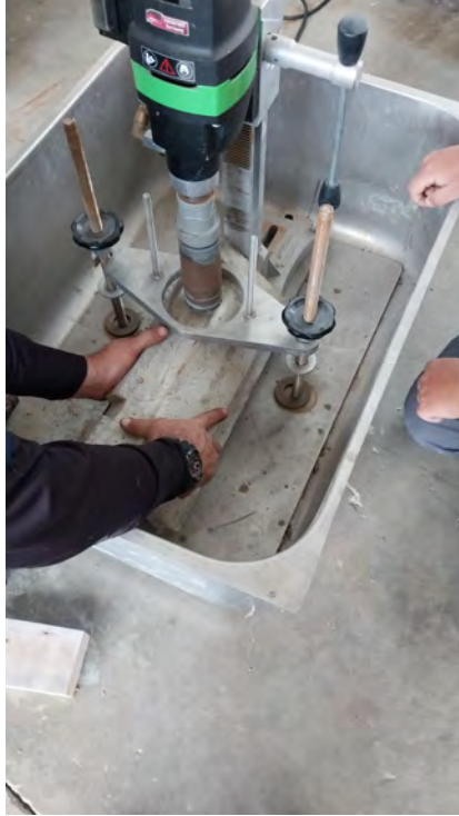
Figura 3.15: Máquina perforadora extractora de núcleos, LANAMME UCR
