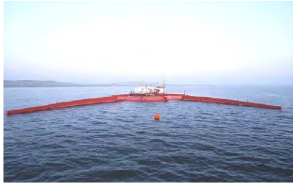
Figura 2.16: Dispositivo Red Dragon, en Dinamarca durante el periodo del 2003 al 2009. Fuente: [Haim, 2021]
