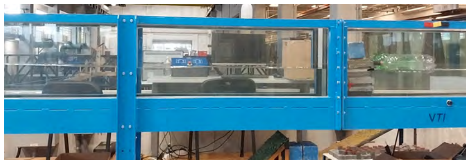
Figura 3.3: Canal de oleaje utilizado en los ensayos
