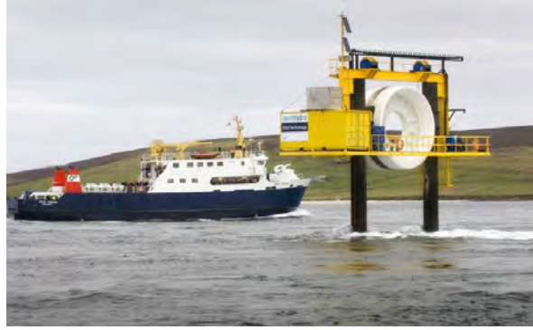
Figura 2.10: Imagen de la turbina de la compañía Open Hydro instalada en costas del Reino Unido. Fuente: [EMEC, 2021]
