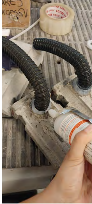
Figura 3.5: Aplicación de silicón para adherir las mangueras al modelo
