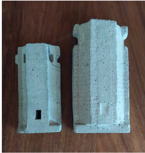
Figura 3.1: Dimensionado de la escala adecuada. A la izquierda escala 1 : 25 a la derecha escala 1 : 20
