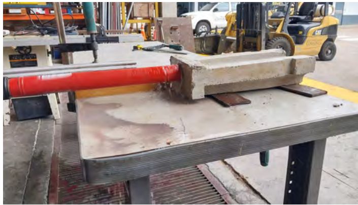
Figura 3.14: Máquina perforadora extractora de núcleos, LANAMME UCR
