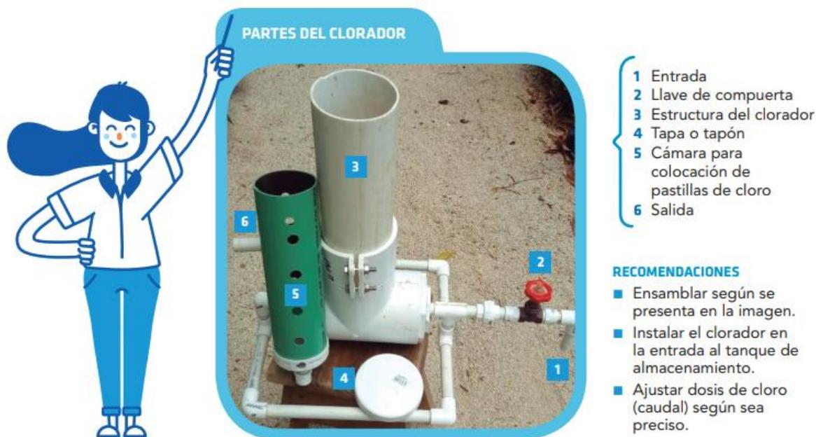
Figura 50. Partes del Clorador
