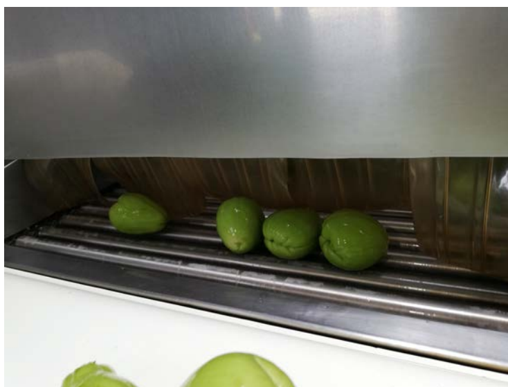
Figura 17: Ingreso a la cámara de encerado.
