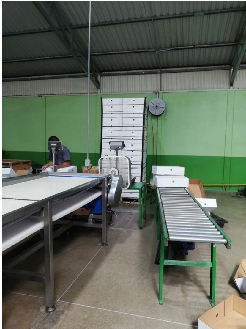
Figura 26: Transportador de rodillos por gravedad (sin motor) de acero inoxidable.
