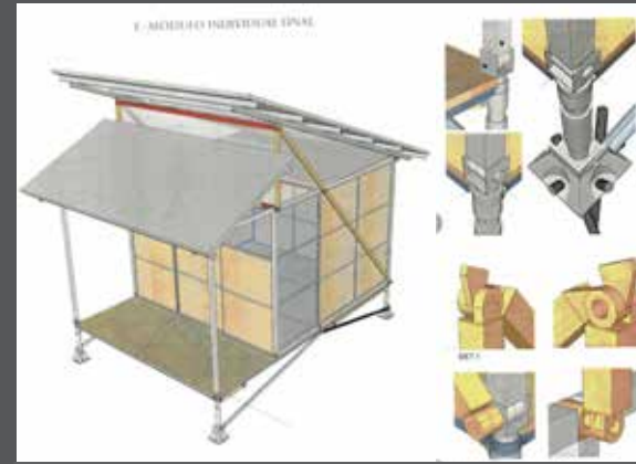
IM.30. El diseño de detalles móviles (no rígidos) permite que las estructuras sean flexibles y de fácil manejo.
