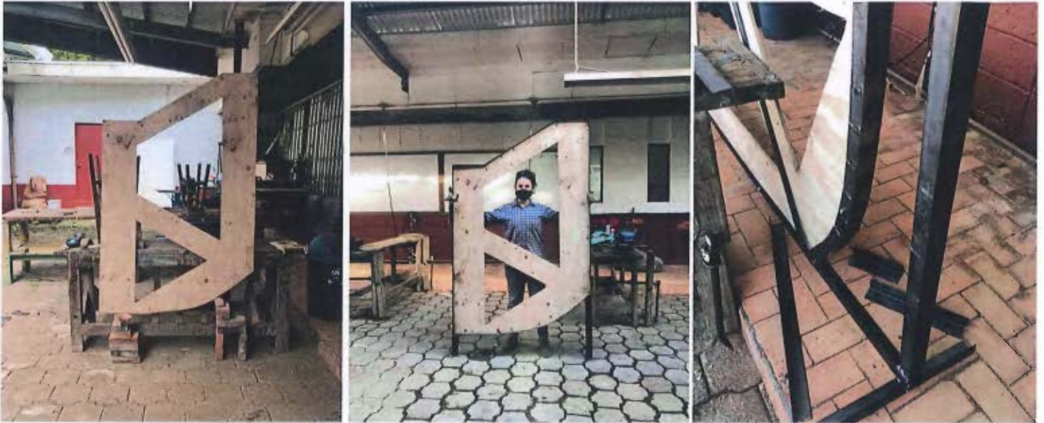
Figura 44: Determinación de la altura y confección de las patas de la estructura
