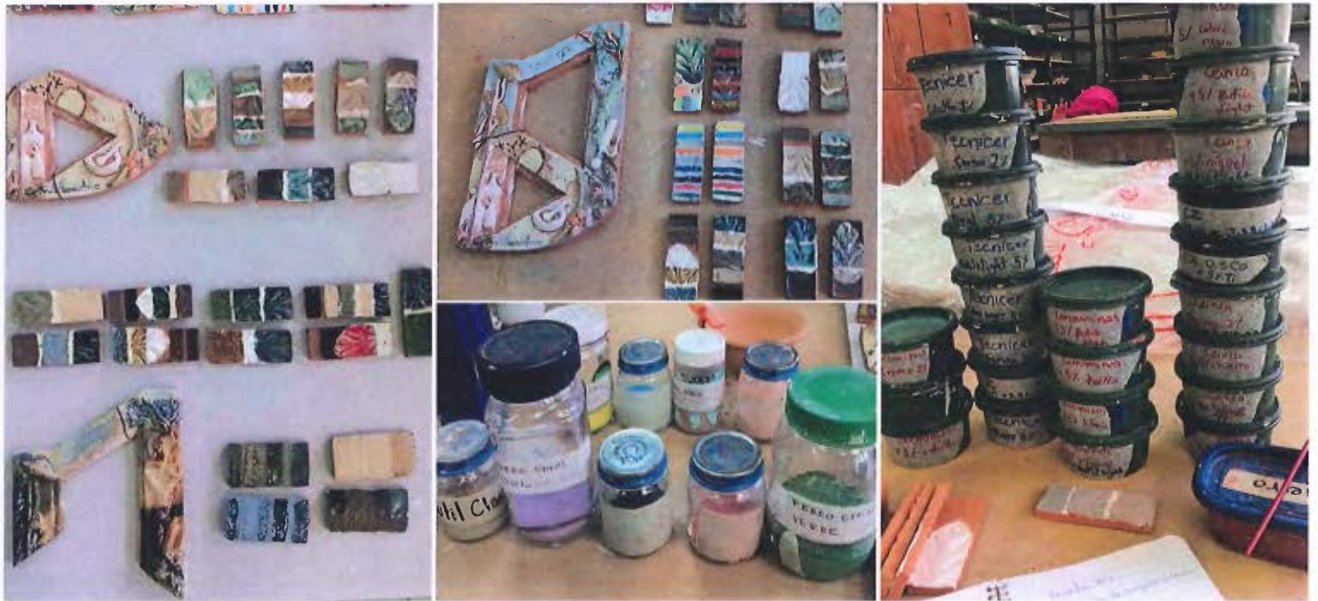
Figura 33: Pruebas de color, obtenidas a partir de las combinaciones con distintos óxidos
