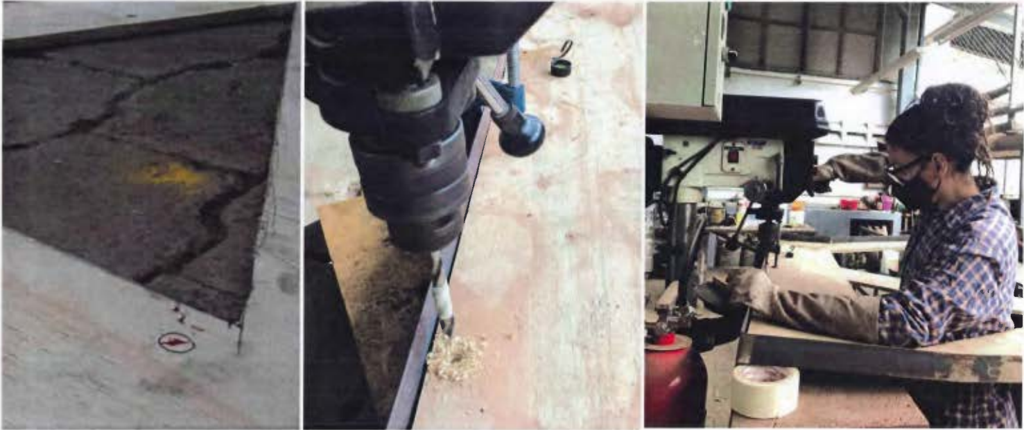
Figura 43: Incorporación de la madera al marco de hierro
