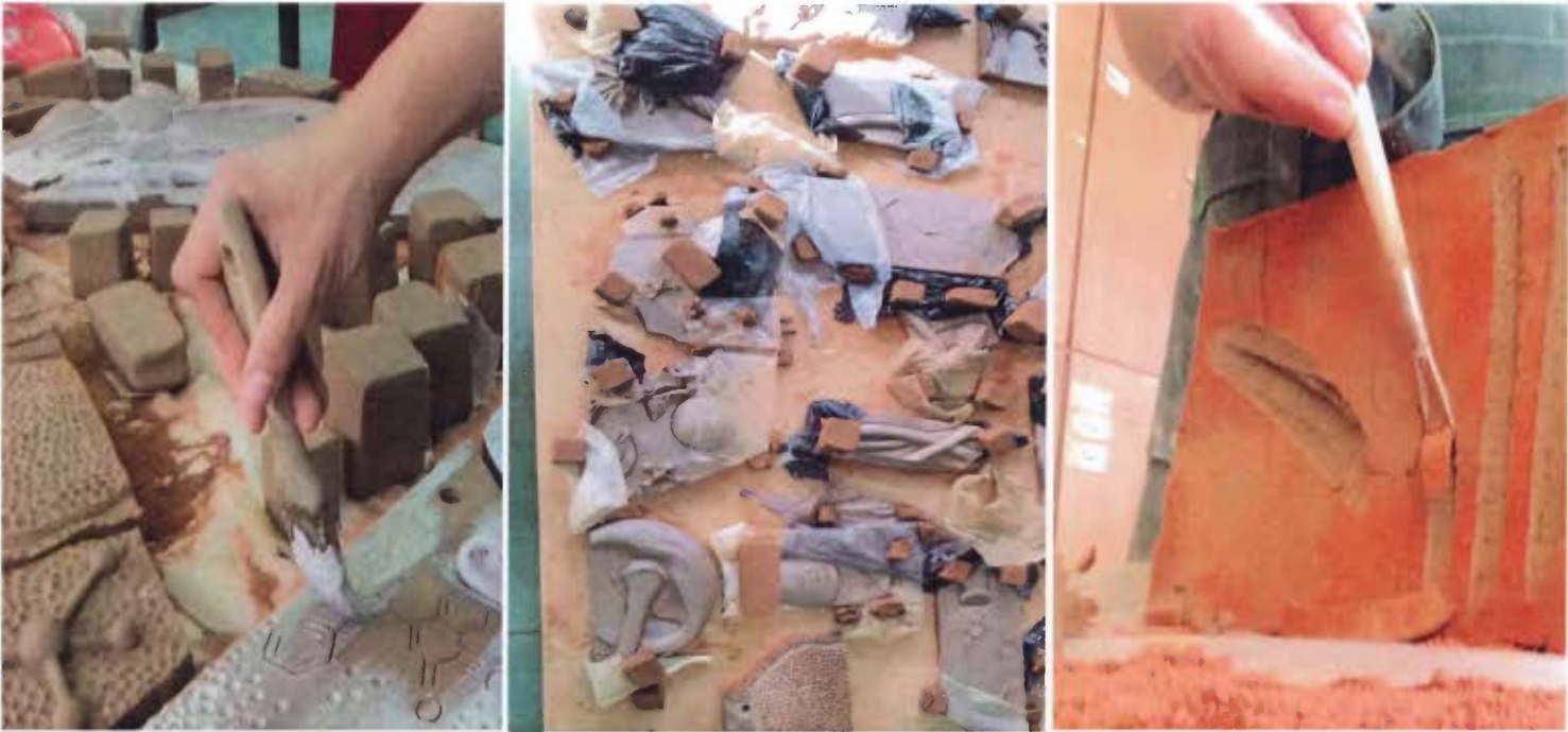
Figura 28: Colocación del engobe de ball clay y vaciado de las piezas
