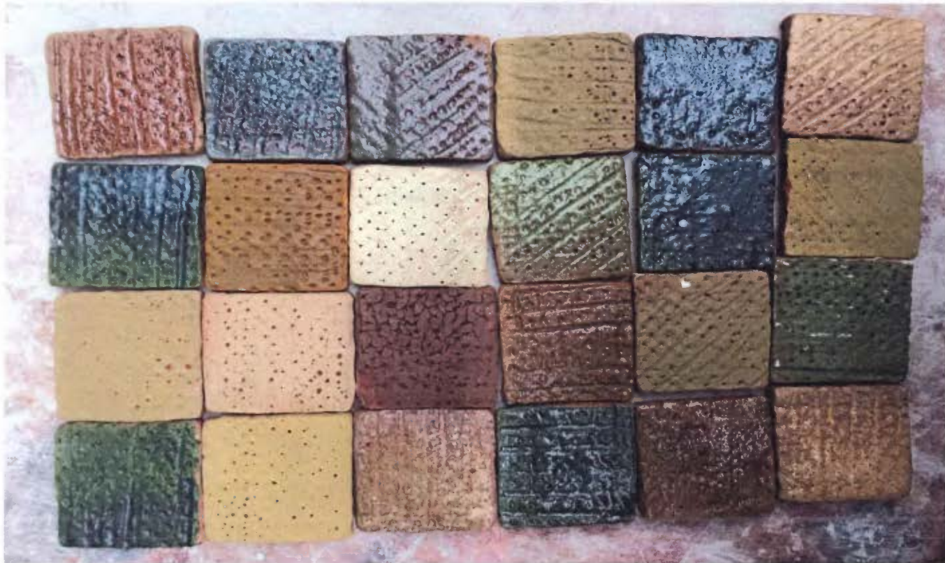
Figura 32: Muestras de los colores de esmaltes obtenidos a partir de las combinaciones con distintos óxidos
