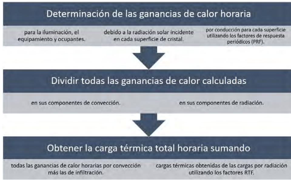
Figura 2.13: Procedimiento general para método SRT. Fuente: [30]
