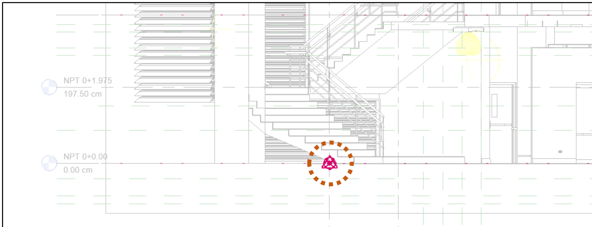
Figura 14. Elevación del origen de coordenadas del proyecto
