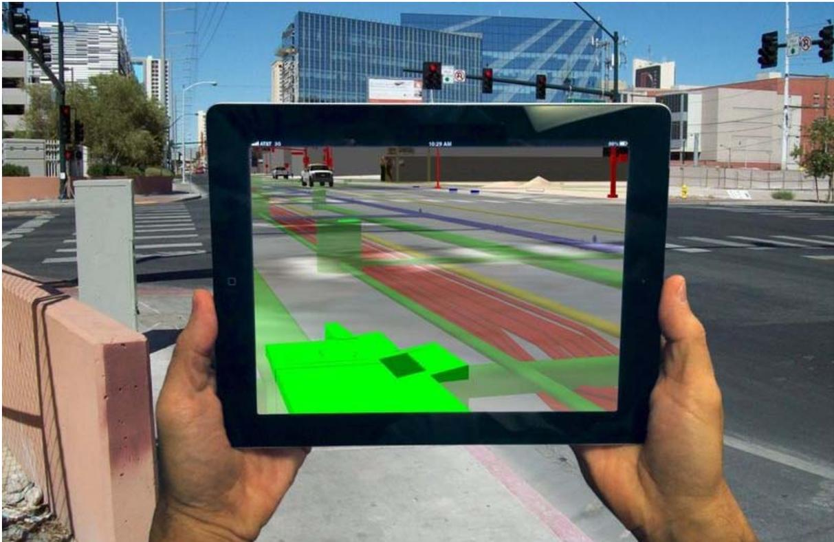
Figura 3-5. Utilización de dispositivo móvil para el control de obra
