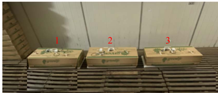
Figura 8. Posicionamiento de las cajas dentro de la cámara de enfriamiento para medir su perfil térmico durante 24 h, caja 1, 2 y3.
