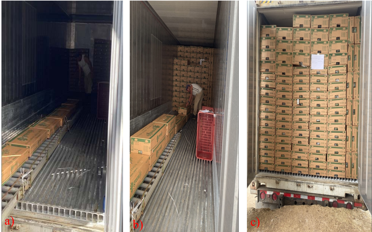
Figura 15. Representación del embalaje de las cajas realizado actualmente. a) es la distribución de la primera fila de cajas, b) acomodo del resto de cajas en el contenedor y c) un detalle de la última fila de embalaje.
