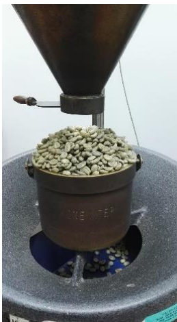
Figura 4: Equipo utilizado para la medición de la densidad aparente.
