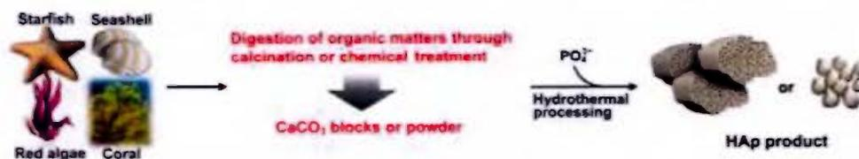
Figura 2: Preparación de HAp a partir de fuentes biogénicas. (Fuente: Sadat et al., 2013).<sup>17</sup>
