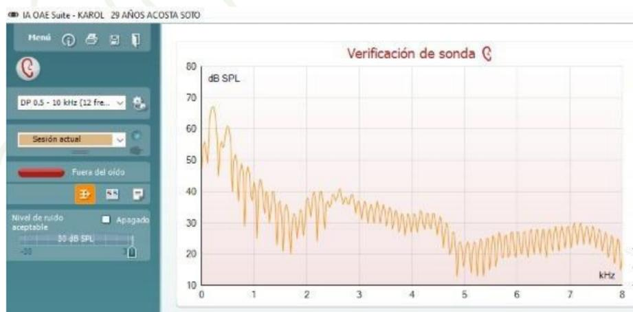
Es necesario corroborar que la sonda se haya colocado de forma correcta, con el hermetismo necesario para evitar fugas que den paso a sonidos artefactos que contaminen las respuestas.
