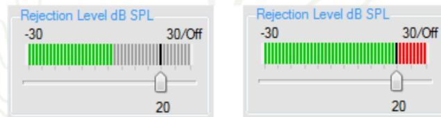
Permite configurar el límite de nivel de rechazo entre los -30 y los +30 dB SPL.
