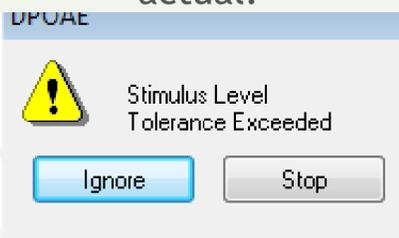
Si se supera el Tolerance Level (Nivel de tolerancia), aparecerá la siguiente ventana emergente.
