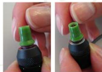
Para acoplar la oliva a la punta de sonda, se debe asegurar que la oliva (1) cubra por completo la base de la sonda (2), para evitar algún tipo de fuga.
