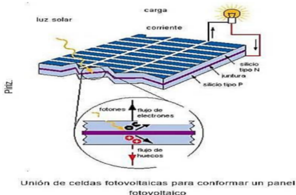
Figura 3.8: Representación gráfica del efecto fotovoltaico [12].
