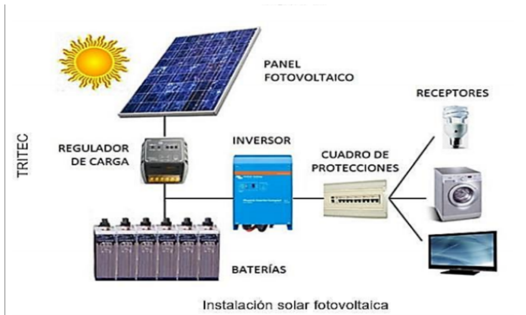
Figura 3.9: Representación gráfica de un sistema fotovoltaico [12].
