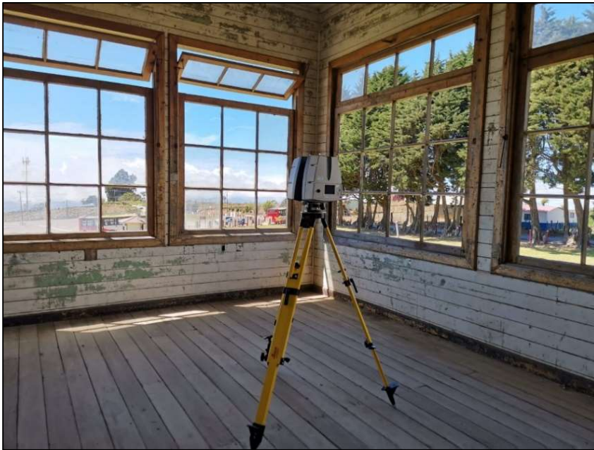
Figura 7. Láser Leica P40 en escaneo de interiores
