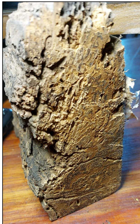
Figura 20. Corte transversal en muestra de vigas
