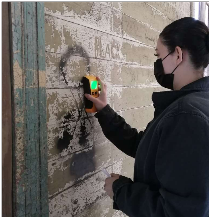
Figura 50. Identificación de columnas dentro de las paredes con detector eléctrico de maderas
