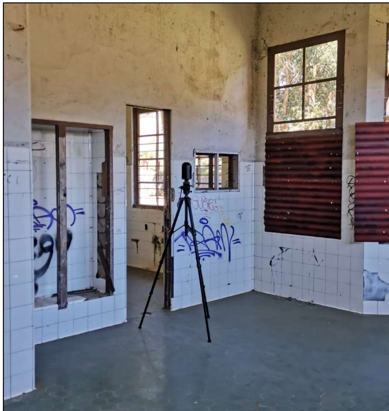
Figura 9. Equipo láser Leica 360 en escaneo de interiores
