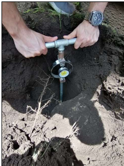
Figura 46. Ensayo con penetrómetro
