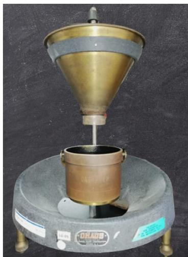
Figura 9. Balanza para peso hectolitro de 1 L de volumen.
