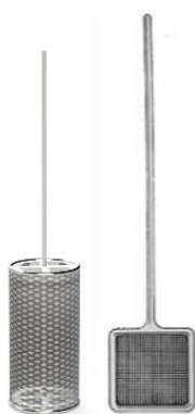
Figura 22. Electrodo separados de malla de platino, EL 04/1 de Platino/Iridio 90:10
