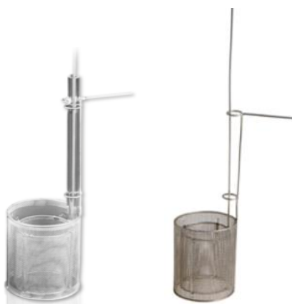
Figura 21. Electrodo concéntrico de platino de tipo Fischer
