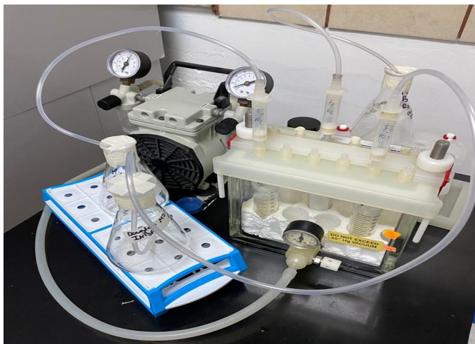
Imagen 1. Sistema utilizado para la SPE de los antibióticos en estudio.
