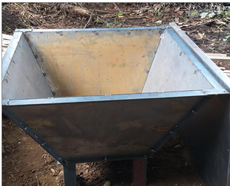
Figura 2. Horno de pirólisis experimental de campo tipo Kon Tiki, para la generación de biocarbón de pinzote de palma aceitera ( Elaeis guineensis ) utilizado en el ensayo en invernadero.
