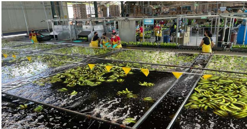
Figura 1. Tanques de lavado o desleche de la Finca San Pablo, CORBANA.
