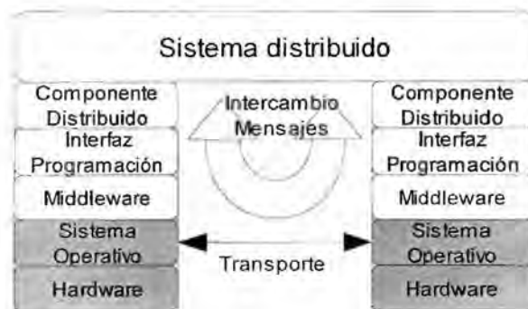
Figura 2.1. Arquitectura de sistema distribuido. El sistema distribuido está compuesto por componentes distribuidos alojados en diferentes nodos. Estos componentes intercambian mensajes usando los servicios de comunicación de las capas inferiores. Cuando el mensaje llega a la capa del sistema operativo, este usa algún protocolo de transporte para transmitir el mensaje hacia el sistema operativo de algún otro nodo.
