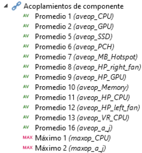
Figura 5.1.3. Módulo de Acople de componentes para la simulación del estado estacionario en COMSOL (Elaboración propia, 2019).
