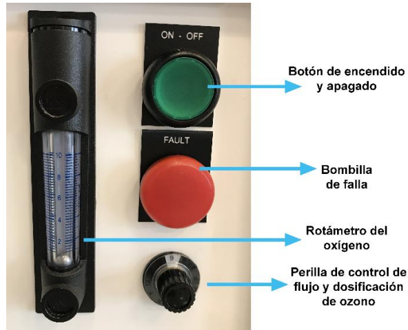
Figura 12. Panel de control del generador de ozono
