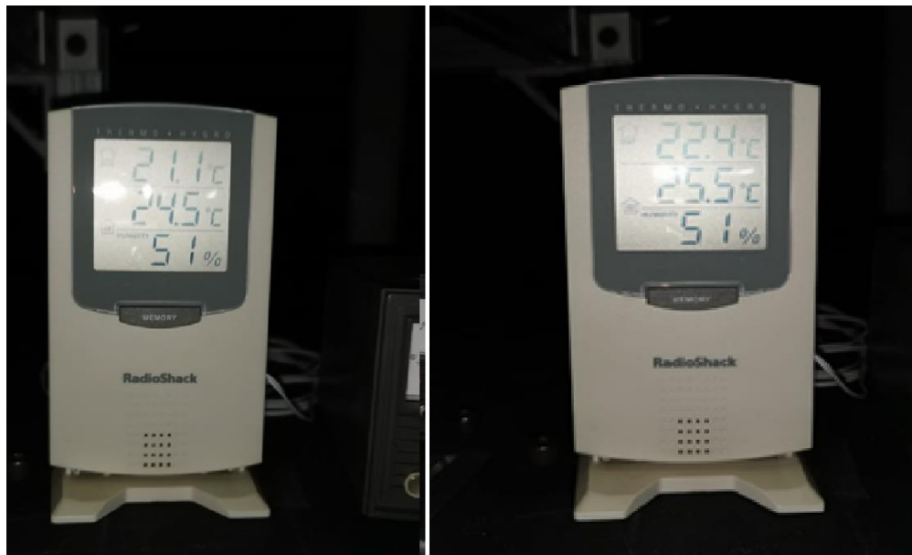
Figura 6.3: Valor máximo y mínimo de la temperatura del laboratorio alrededor de la lámpara durante la medición.
