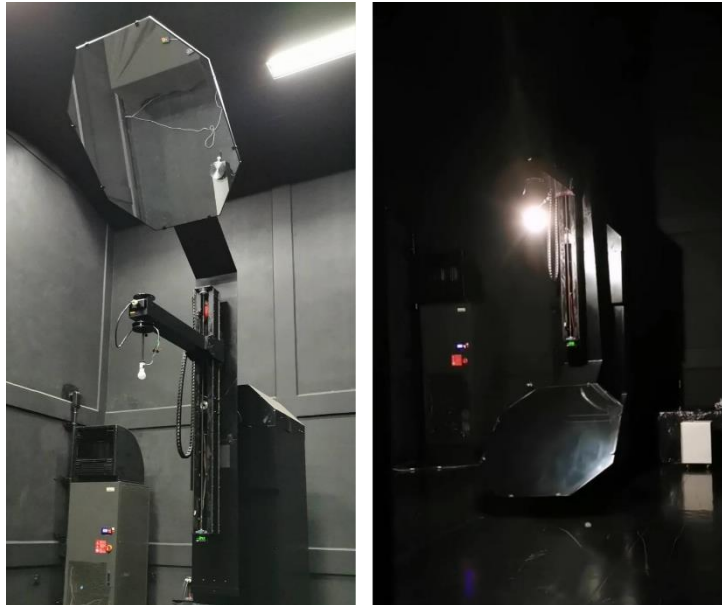
Figura 6.1: Goniofotómetro del LEE, ICE. (a) Posición cero (b) Medición en elevación a 180 grados
