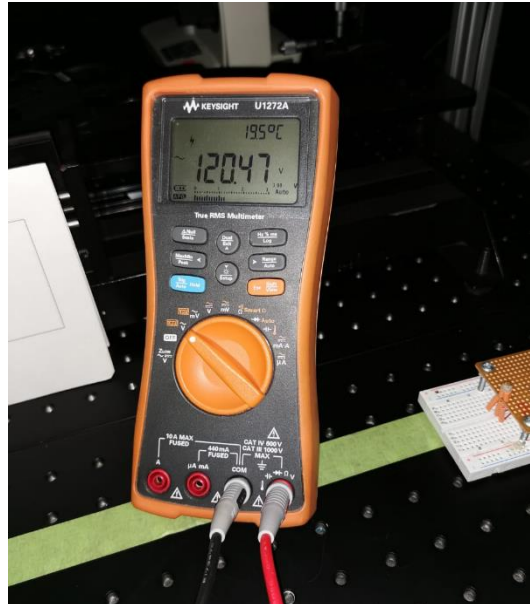
Figura 6.4: Ejemplo del valor de la tensión eléctrica utilizada para alimentar la lámpara.
