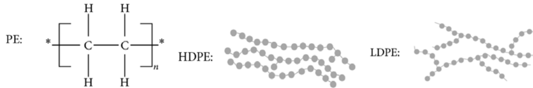
Figura 2.11. Monómero y moléculas de polietileno de alta y baja densidad.
