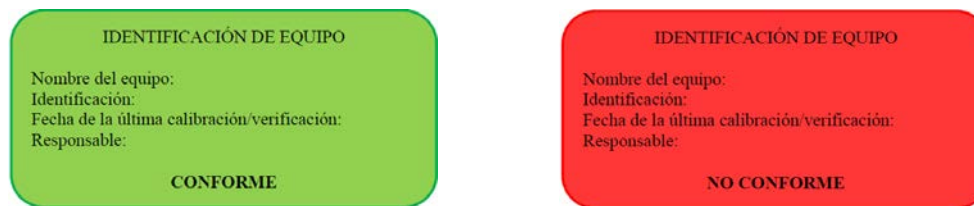
Figura 5.1. Sistema de etiquetado de equipos empleado en el laboratorio (LANOTEC, 2018)
