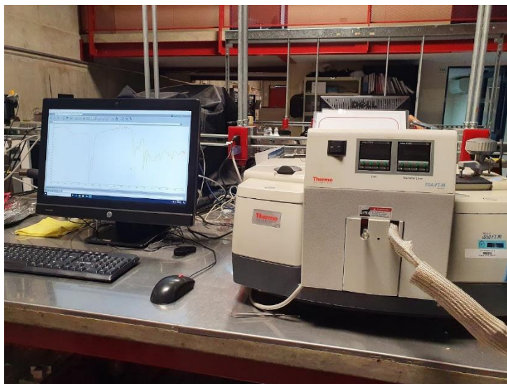
Figura 3.11. Equipo utilizado para la aplicación de la técnica de Espectroscopia Infrarroja (FTIR).
