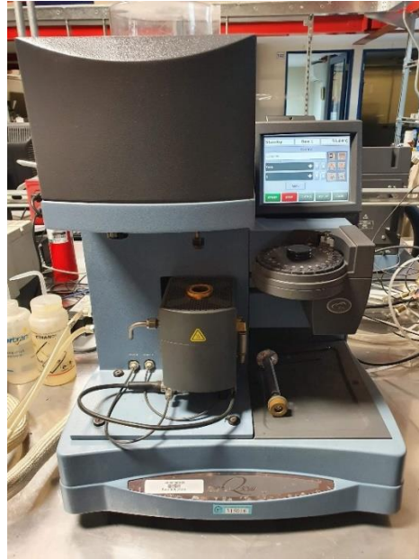
Figura 3.2. Equipo utilizado para aplicar la técnica de termogravimetría.
