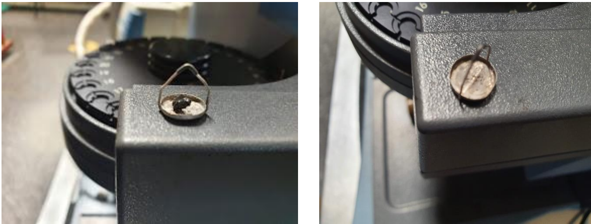
Figura 3.5. Muestra de asfalto antes y al finalizar el ensayo de termogravimetría.
