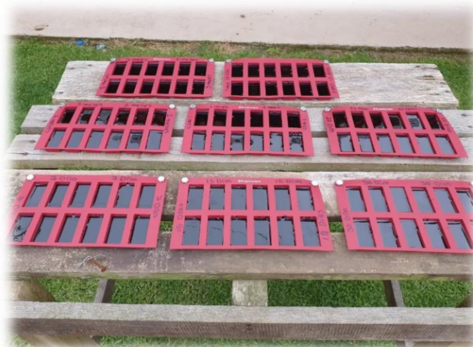
Figura 3.10. Estación experimental para la exposición de muestras a los distintos factores ambientales.
