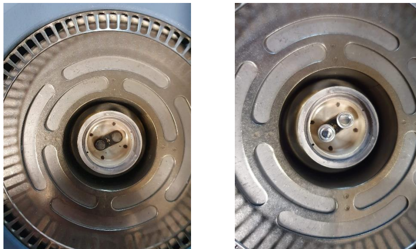
Figura 3.6. Compartimento donde se coloca las muestras a analizar y compartimento con el porta muestras de referencia y la muestra a analizar.
