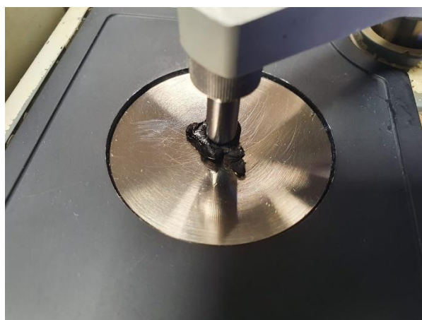
Figura 3.12. Muestra lista para ser analizada mediante la técnica de Espectroscopia Infrarroja.
