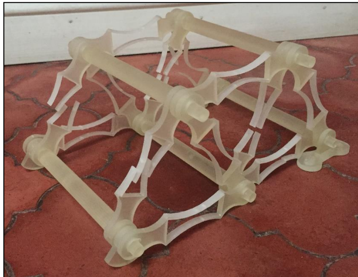
Figura 6. Elemento de cercha impreso en 3D utilizando tecnología de fotopolimerización.
