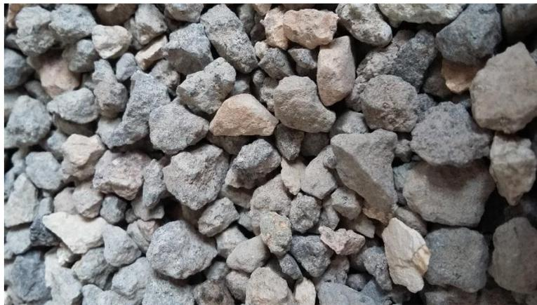
Figura 21. Material granular utilizado como sedimento en pruebas de laboratorio
