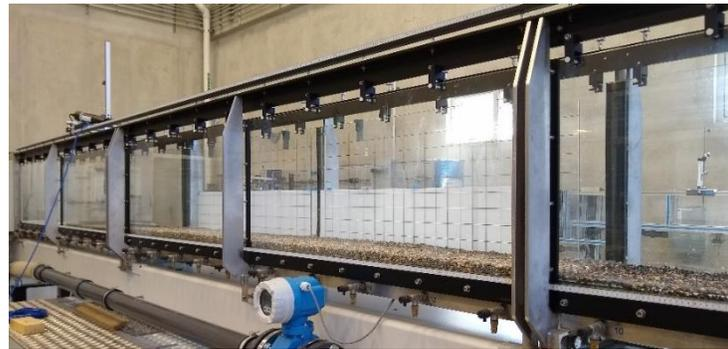
Figura 17. Fondo del canal de laboratorio cubierto con grava para pruebas de iniciación del transporte
