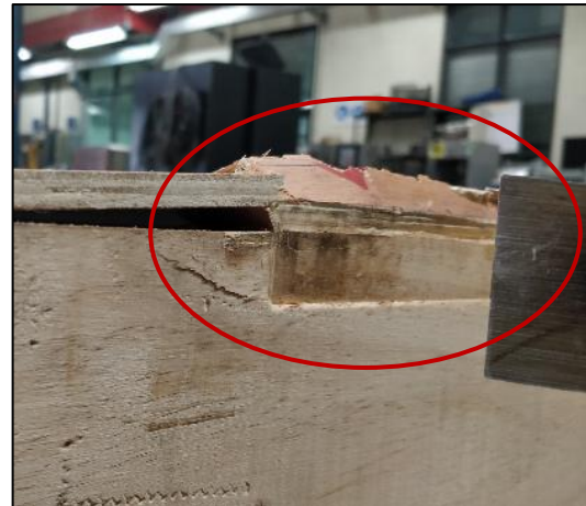
Figura 77. Aplastamiento en punto de carga
