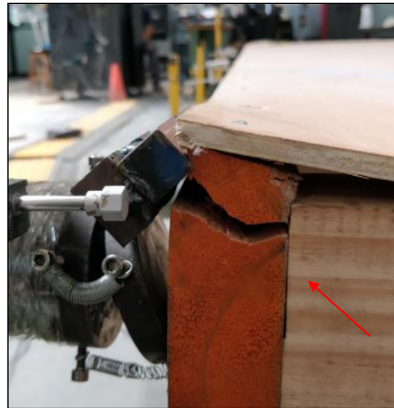
Figura 85. Falla en sección de madera aserrada
