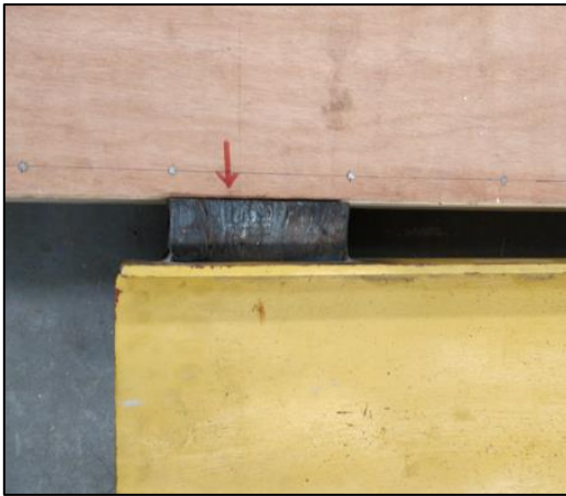
Figura 74. Punto de carga previo a la falla
