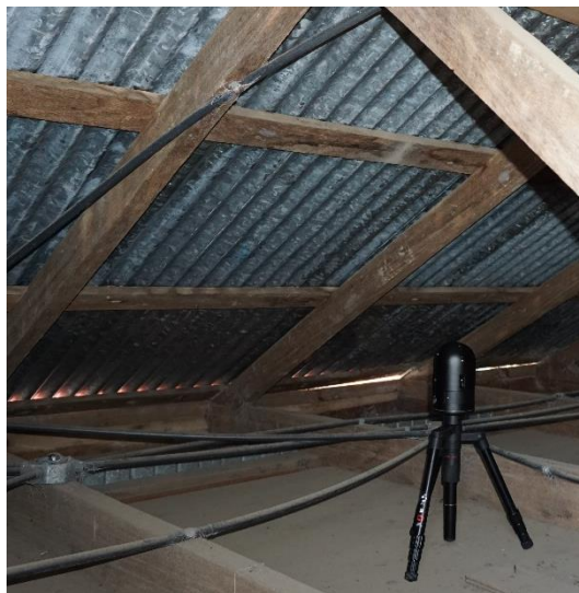
Figura 9. Escáner láser de imágenes Leica BLK360 Tomada por: Corrales, 2020
