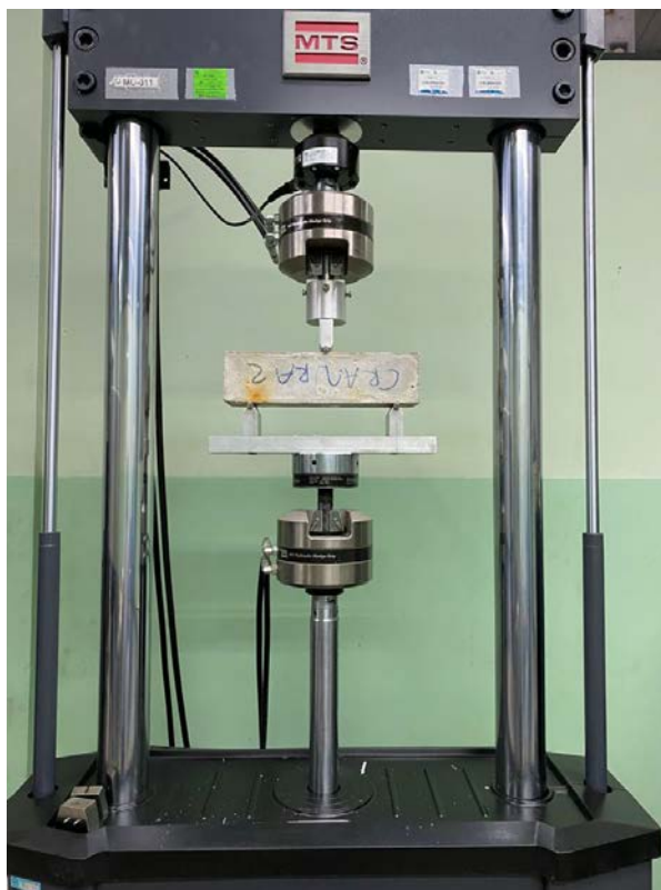
Figura 26. Viga de concreto de relleno fallada por flexión
