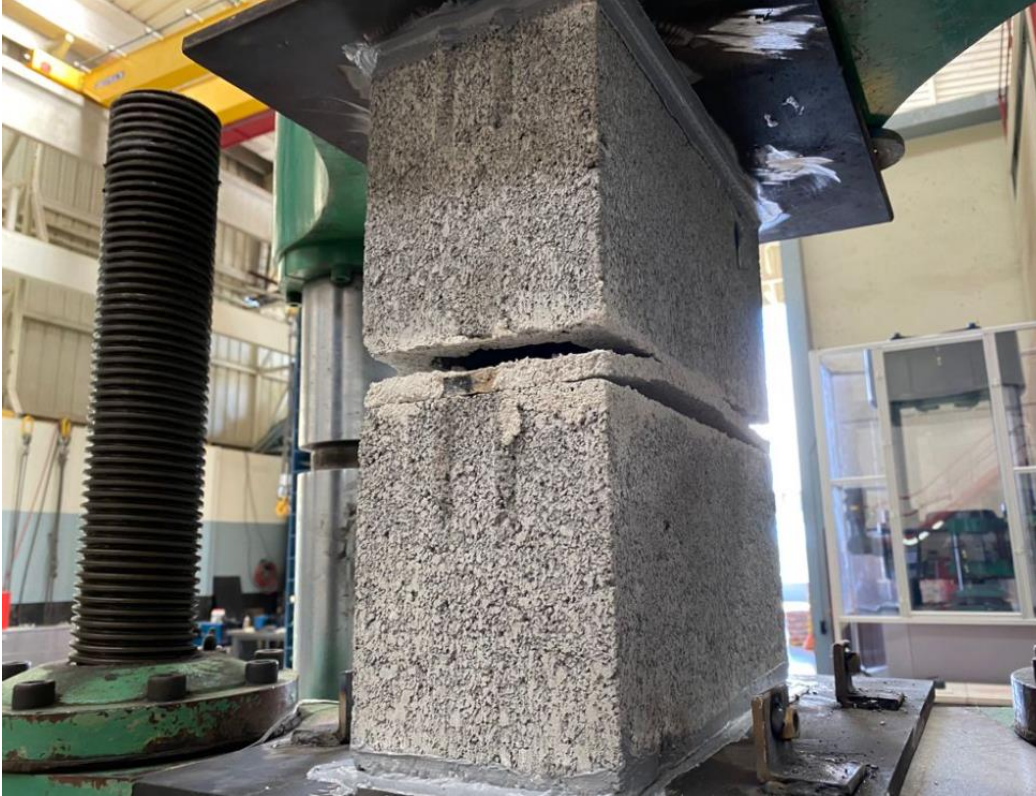
Figura 34. Falla en la prueba de tensión de la interfaz horizontal
