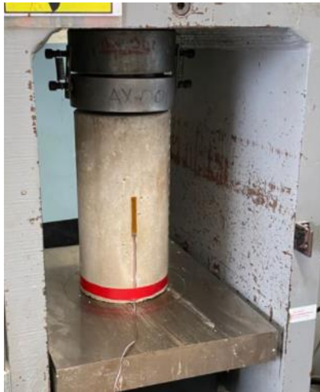
Figura 25. Falla de cilindro de mortero
