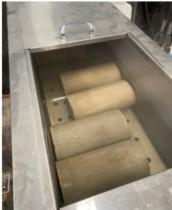
Figura 27. Cilindros de mortero y de concreto de relleno hervidos para obtener peso hervido
