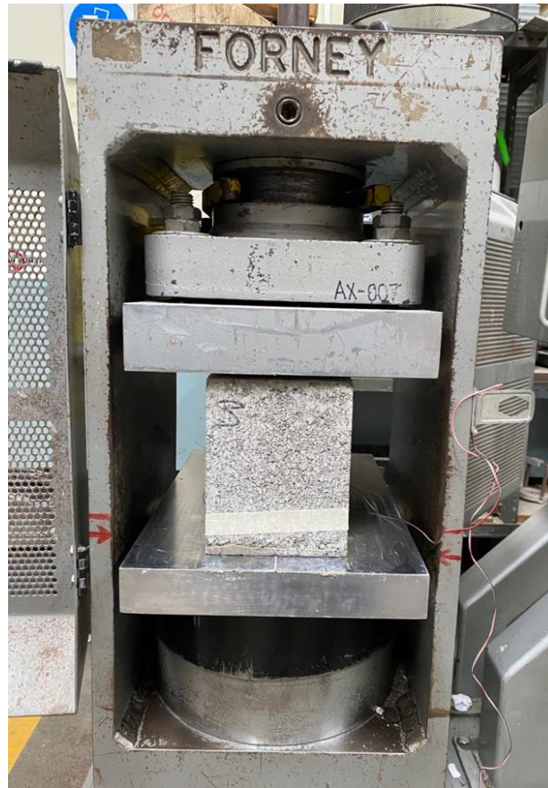
Figura 21. Montaje de prueba para medir resistencia a compresión de los bloques de concreto
