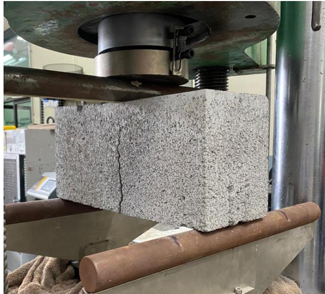
Figura 23. Montaje del ensayo para obtener el esfuerzo por flexión de un bloque de concreto
