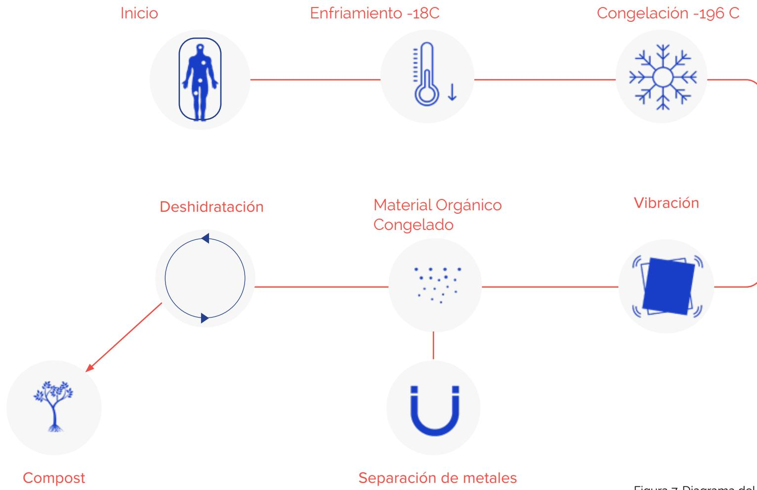
Figura 7. Diagrama del proceso del Método para el tratamiento del cuerpo con Nitrógeno Líquido.
