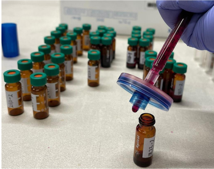
Figura 6. Microfiltración del jugo de pitahaya con filtro de 0,2\ \mu\text{m} en viales para análisis de betalaínas en HPLC.
