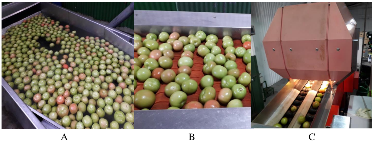
Figura 11. Lavado/desinfección (A), secado (B) y sistema de fotografía (C) del tomate en la planta empacadora de la finca hidropónica. Elaboración propia
