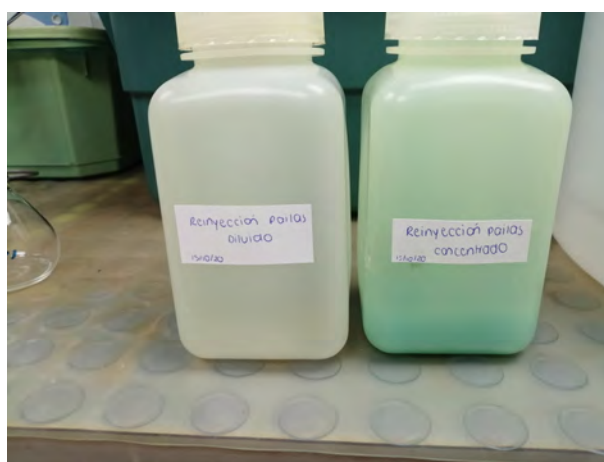
Figura 5.29. Contaminación de las muestras producto del desprendimiento de cobre del electrodo en el compartimiento anódico (Elaboración propia)
