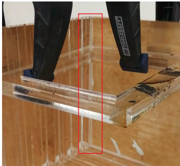
Figura 5.28. Película formada por el uso de pegamento como método de unión entre piezas de acrílico (Elaboración propia)
