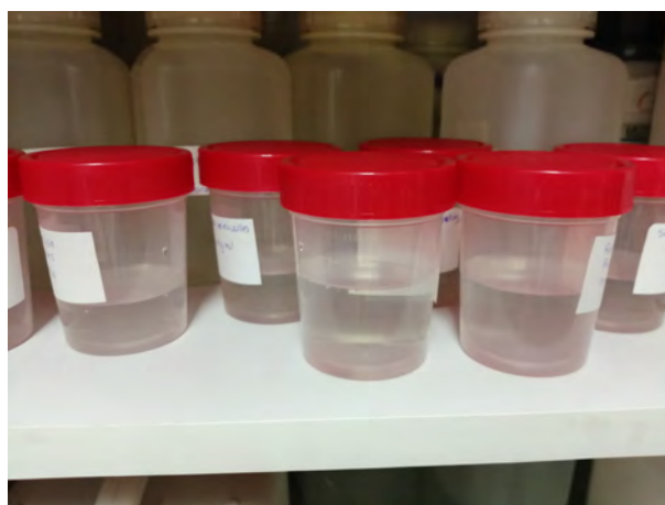
Figura 5.30. Recipientes con las muestras concentradas, posterior a una filtración, enviados para el análisis de cuantificación de especies (Elaboración propia)
