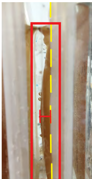
Figura 5.25. Membrana inflada cuando se encuentra en contacto con líquido (Elaboración propia)
