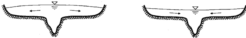
a) Pendiente transversal durante el aumento de la creciente. b) Pendiente transversal durante la recesión de la creciente.
