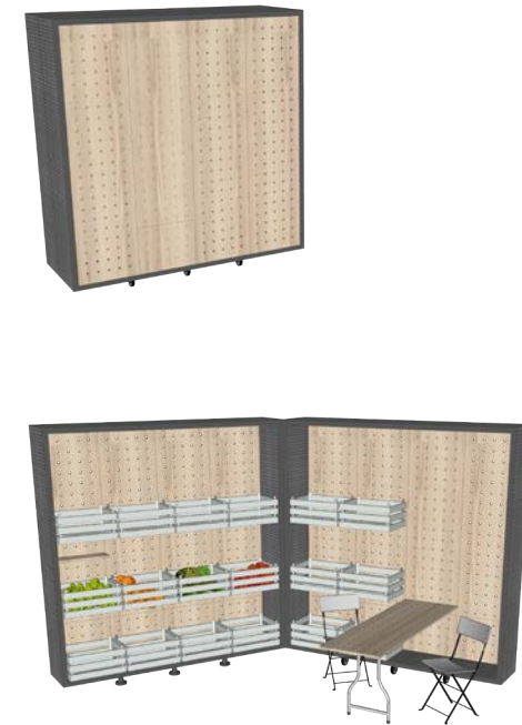
Figura 41. Puesto de mercado Muestra como el puesto de mercado se puede cerrar durante las horas que permanece cerrado para proteger productos Imagen de Cartin Hidalgo, D. (2021).
